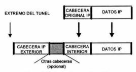
Figura 3.10 Encapsulamiento IP-in-IP
