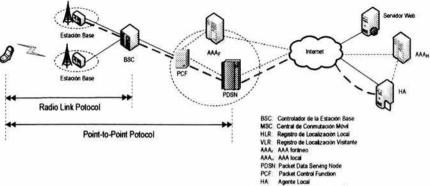
Figura 2.4 Trayectoria de una llamada de datos en CDMA2000 1x
