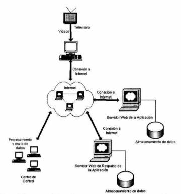
Figura 5.9 Componentes de la arquitectura concernientes al manejo del contenido
