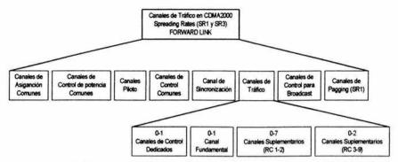
Figura 2.13 Configuración de los Canales de Tráfico dentro del Forward Link de CDMA2000® 1x
