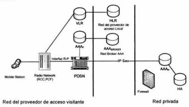
Figura 3.17 Arquitectura de una MVPN dentro de CDMA2000® 1x
