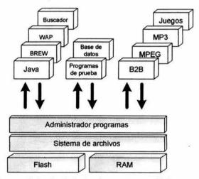
Figura 4.5 Diagrama de distribución de cómo los requerimiento del desempeño de la memoria son dados para la gama de protocolos y aplicaciones que maneja un teléfono 3G
