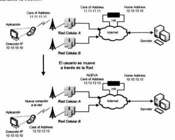
Figura 3.3 Manejo de las direcciones dadas a un móvil: Home Address y Care-of-Address
