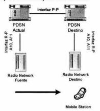
Figura 3.15 Proceso de Handoff Inter PDSN
