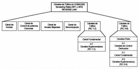
Figura 2.14 Configuración de los Canales de Tráfico dentro del Reverse Link de CDMA2000® Ix
