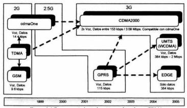
Figura 1.6 Convergencia hacia los sistemas basados en CDMA
