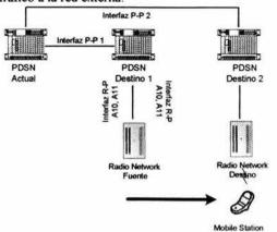
Figura 3.16 Proceso de Handoff Inter PDSN
