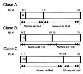
Figura 3.2 Configuración de las Clases de Dirección IP
