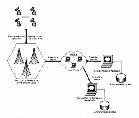
Figura 5.8 Componentes de la arquitectura que intervienen directamente en la etapa móvil
