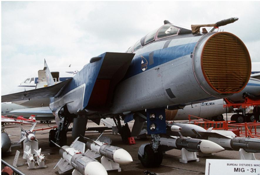
Figura 1.8: Phased array tipo PESA instalado en la punta de un avión de combate. "What is a Phased Array Antenna?" Recuperado de [7].
