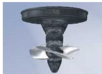
Figura 4.12: Rodete de Turbina Helice.
