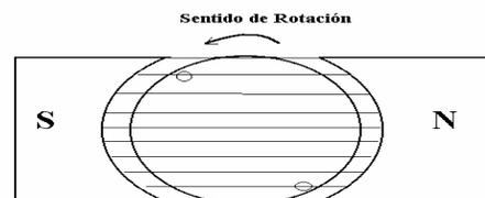
Figura 5.3. El alternador elemental consiste en una sola bobina montada en una armadura de hierro que gira en un campo magnético uniforme. El voltaje inducido por la bobina es proporcional al ritmo con que se cortan las líneas de fuerza del flujo magnético.
