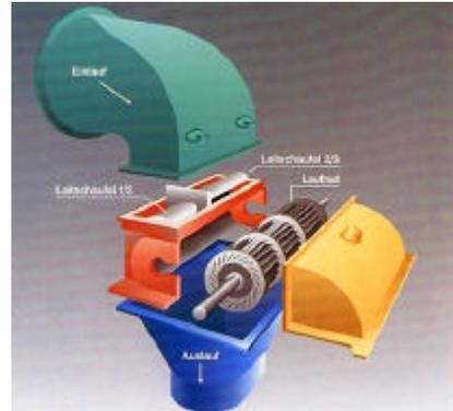
Figura 4.8: Turbina de Doble Impulsión.
