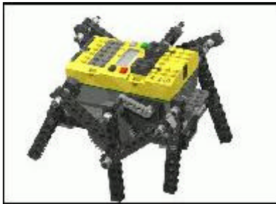
Figura 9a. Primer prototipo de seis patas
