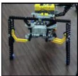
Figura 10. Patas delanteras, motores y engrane
