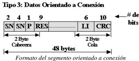
El Número de Secuencia **SN** se emplea para detectar segmentos perdidos o duplicados y también para control de flujo. Un único bit de Prioridad **P** permite que los segmentos tengan uno de dos niveles de prioridad. En la cola, el Indicador de Longitud **LI** indica el número de bytes útiles en el segmento y el CRC-10 está presente para la detección y eventual corrección de errores. Claramente LI solamente tiene significado en el último segmento de una SDU o si es el único segmento.
