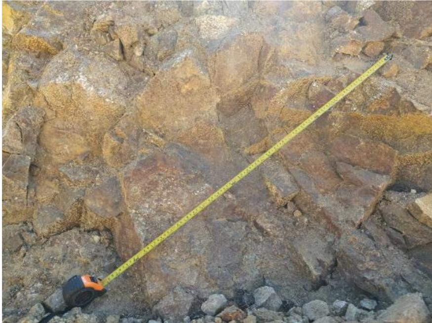
*Foto 4.3 Pórfido andesítico intensamente meteorizado.*
