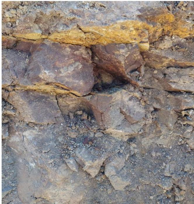
*Foto 4.4 Oxidación formada en las fracturas.*
