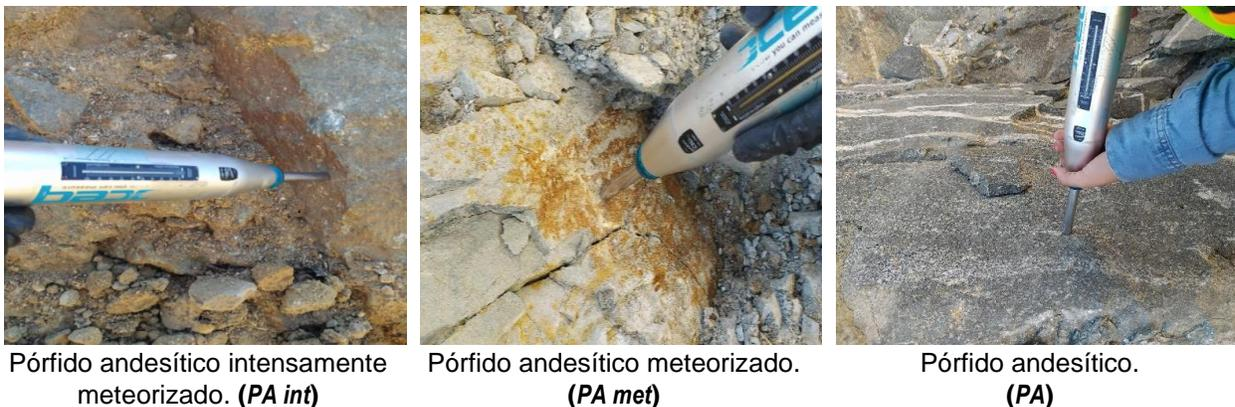
Foto 4.9. Prueba con esclerómetro sobre el pórfido andesítico.
