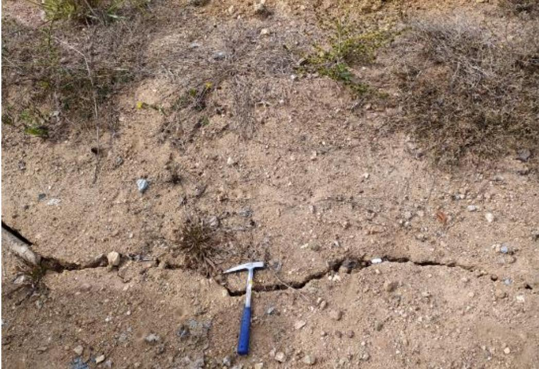
*Foto 4.10 Grieta de tensión presente en la corona del talud.*
