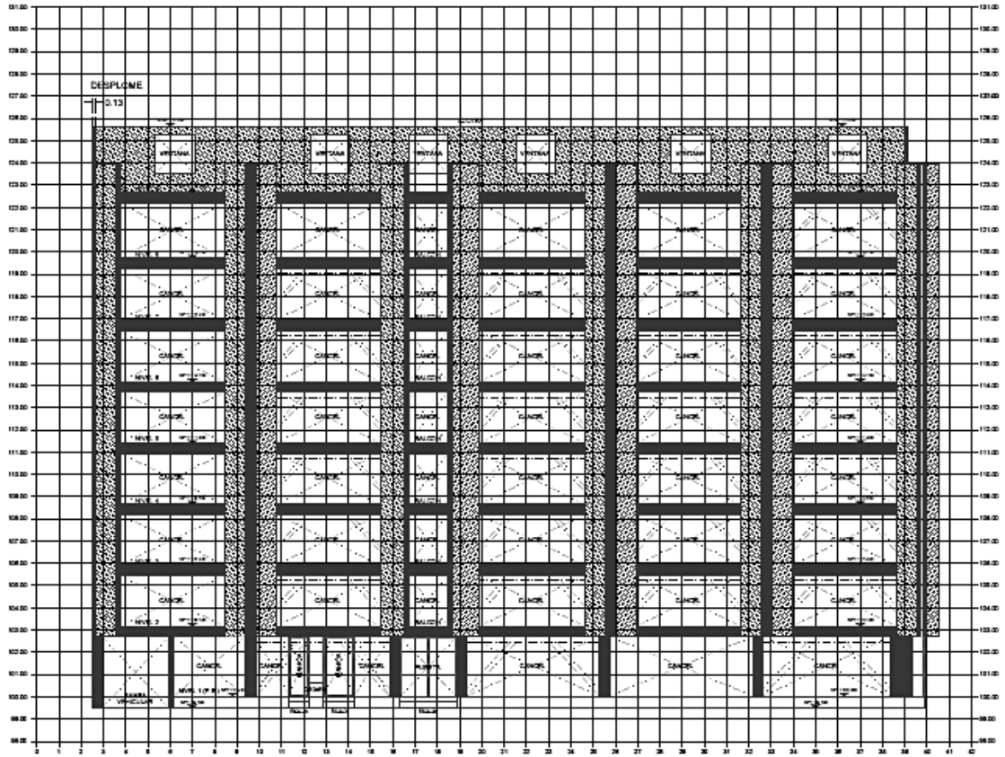
Figura 4 Fachada calle Cienfuegos, levantamiento topográfico.
