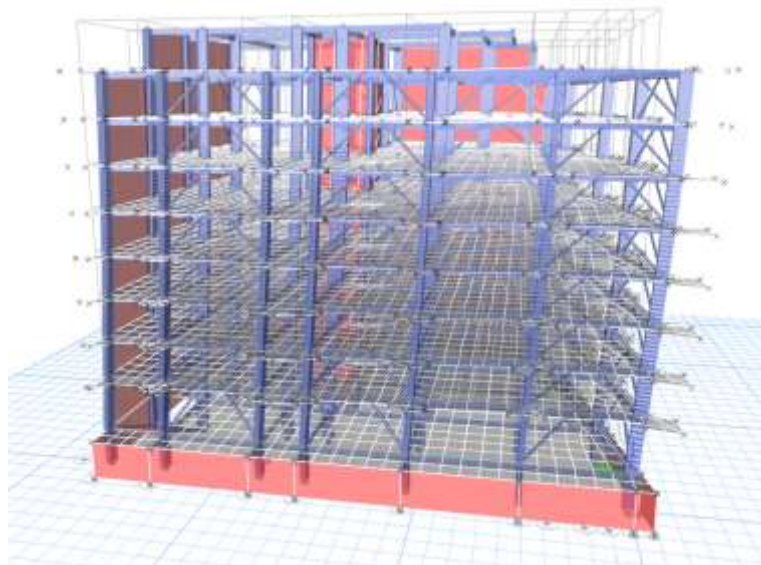
Figura 30 Segundo modo de vibrar 0.937seg, vista 3D.
