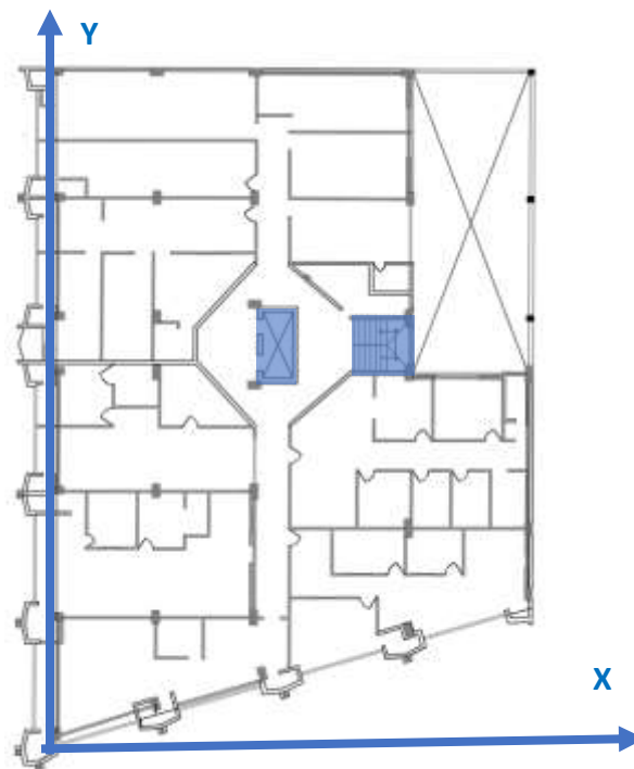
Figura 16 Aberturas en sistema de piso
