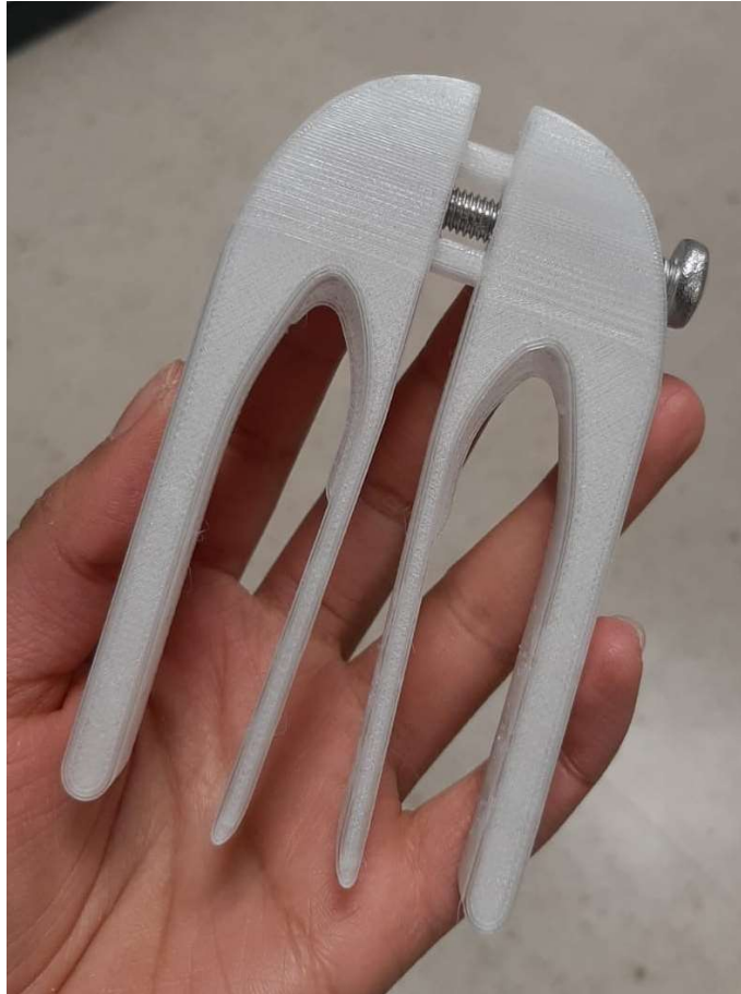
Figura 5.20 Prototipo final realizado en PETG, con postproceso.
