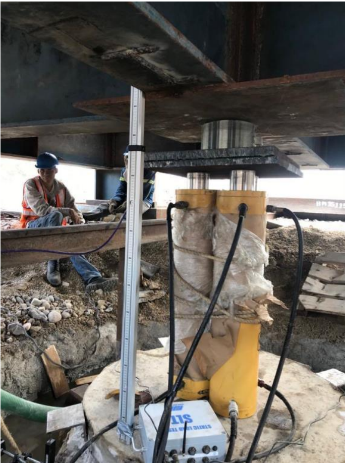
Imagen 9: Arreglo de captura de datos SLT (Static Load Testing) y aplicación de carga.
