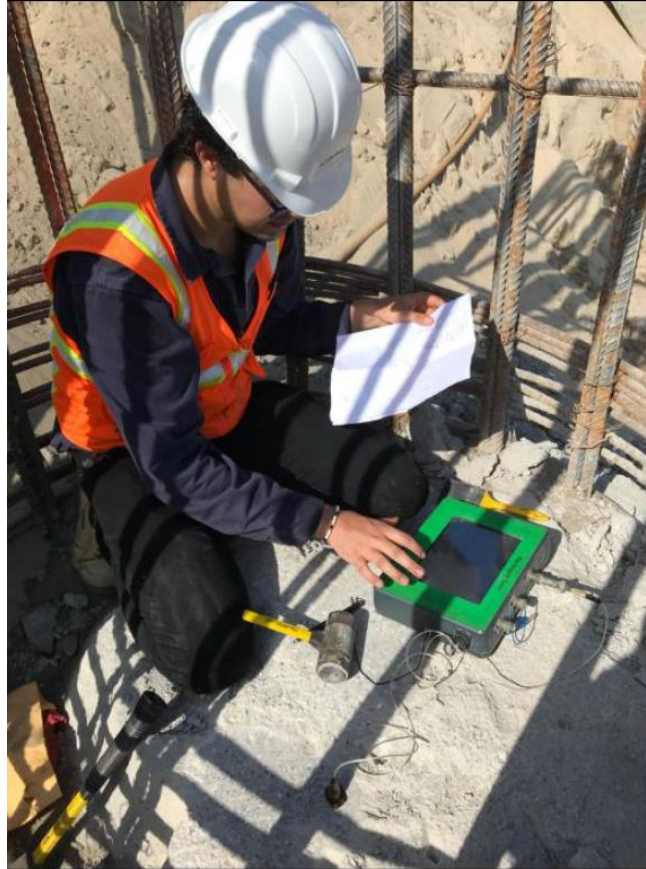
Imagen 5: Arreglo típico de captura de campo para la prueba de integridad PIT.
