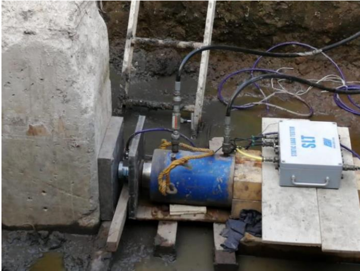
imágenes 12 y 13: Arreglo de carga y medición de prueba de carga lateral.
