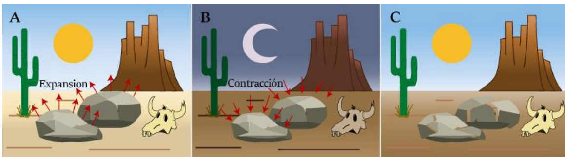
Figura 6.2 A) Las rocas se expande por el aumento de temperatura. B) Las rocas se contraen al disminuir la temperatura C) Por la expansión y contracción la roca se fragmenta.
