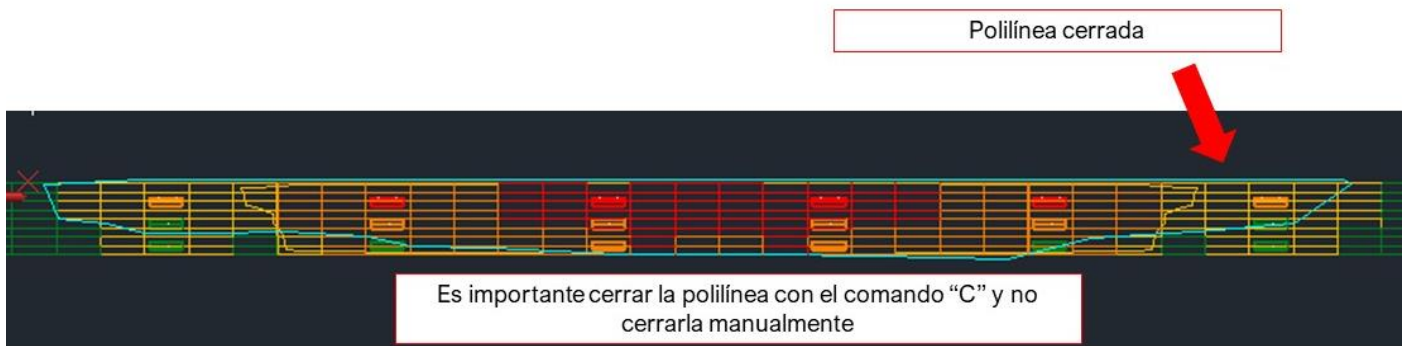
Figura C 35. Polilínea cerrada en sección con compósitos y modelo de bloques..
