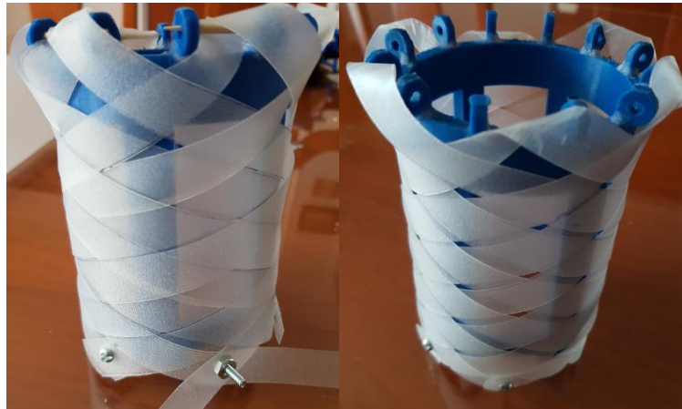
Figura 3.15 Entramado de las tiras y retiro del elemento fijador.
