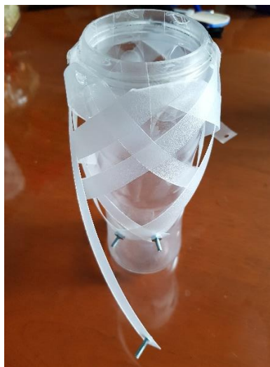
Figura 3.9 Proceso de entramado con molde provisional aproximado al diámetro deseado, usando cinta adhesiva para fijar las tiras en posición deseada
