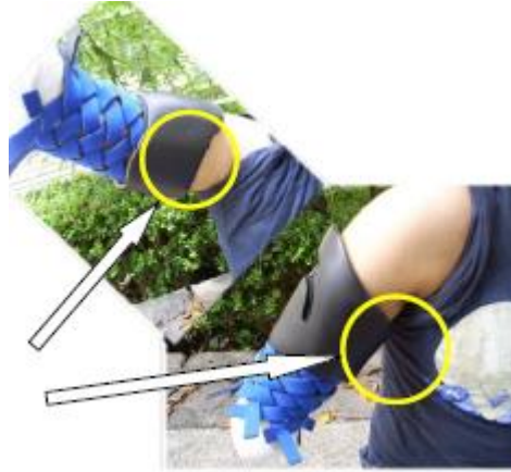
Figura 2.14 Prueba de colocación del socket rígido [10]
