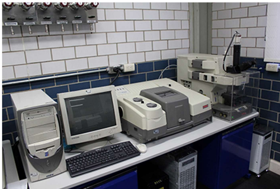
Figura 4.5. Equipo de Espectroscopia FTIR-ATR Thermo Nicolet NEXUS 670 FTIR
