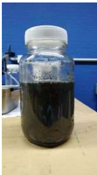
Figura 4.2. Imagen de coloide obtenido mediante el método de Hummers
