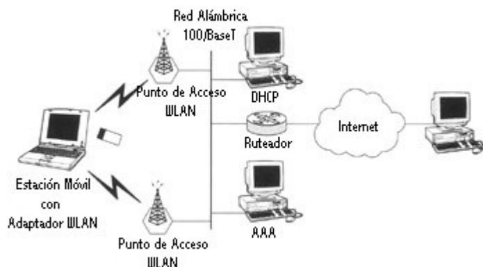
**Figura 3.7** Topología típica de una WLAN
