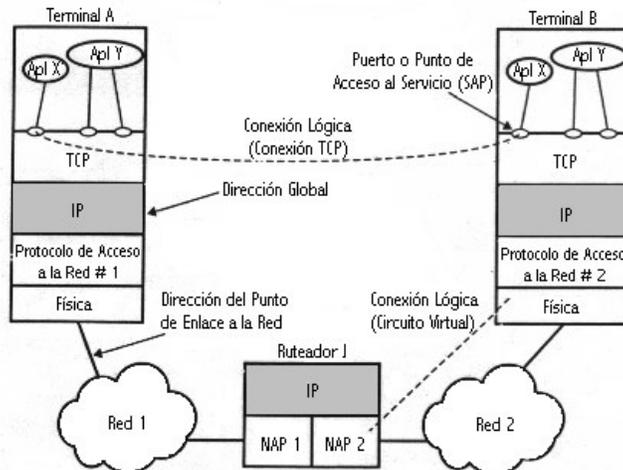
**Figura 6.1** Conceptos de Direccionamiento
