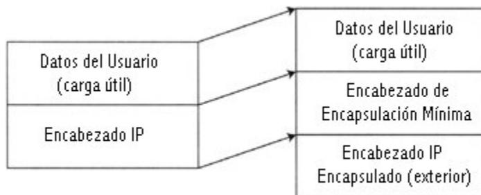
**Figura 2.3** Encapsulación mínima para IP.
