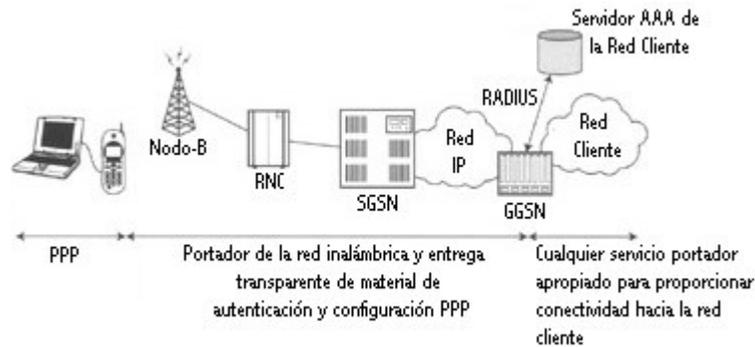
Figura 7.2 Arquitectura IP con modo de acceso basado en PCO
