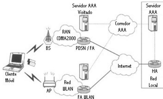
**Figura 11.5** Integración WLAN/Celular basada en IP Móvil
