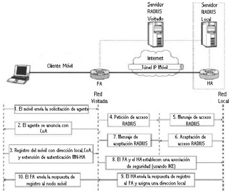
**Figura 2.5** Procedimiento de registro en IP Móvil
