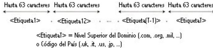
**Figura 2.16** Ejemplo de la estructura para el nombramiento de la terminal
