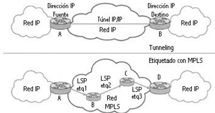
**Figura 2.10** MPLS (etiquetado) vs *tunneling*
