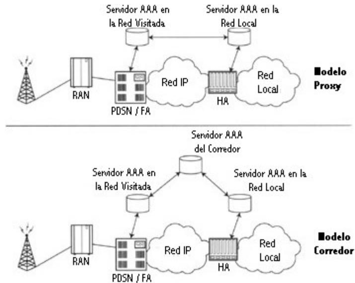
**Figura 2.14** Ejemplos de la arquitectura de AAA en los modelos proxy y corredor: CDMA2000
