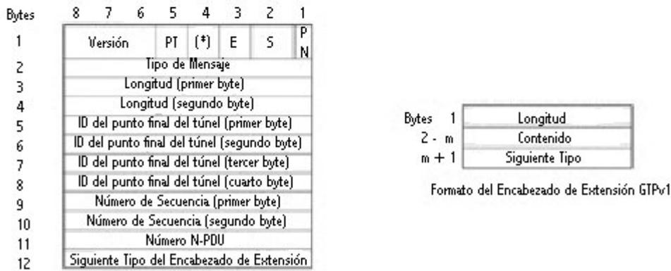
**Figura 2.6** Encabezados de GTPv0 y GTPv1
