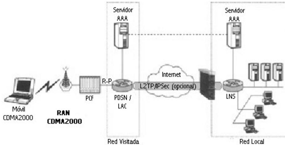
Figura 7.9 Modelo de la arquitectura VPN en IP Simple.
