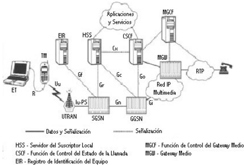
**Figura 11.1** Arquitectura simplificada del subsistema IMS
