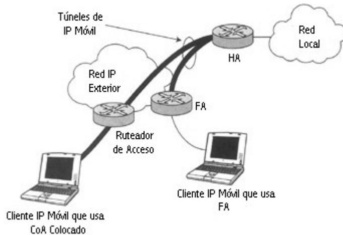
**Figura 2.4** Modelo de IP Móvil
