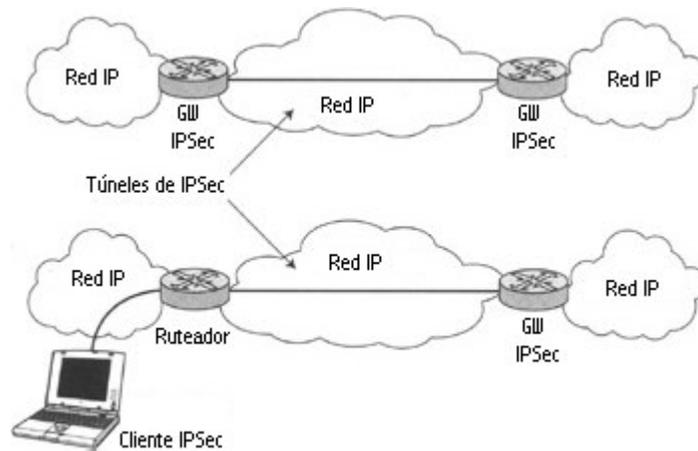
**Figura 2.8** Arquitectura de IPSec (*gateways* y terminales).
