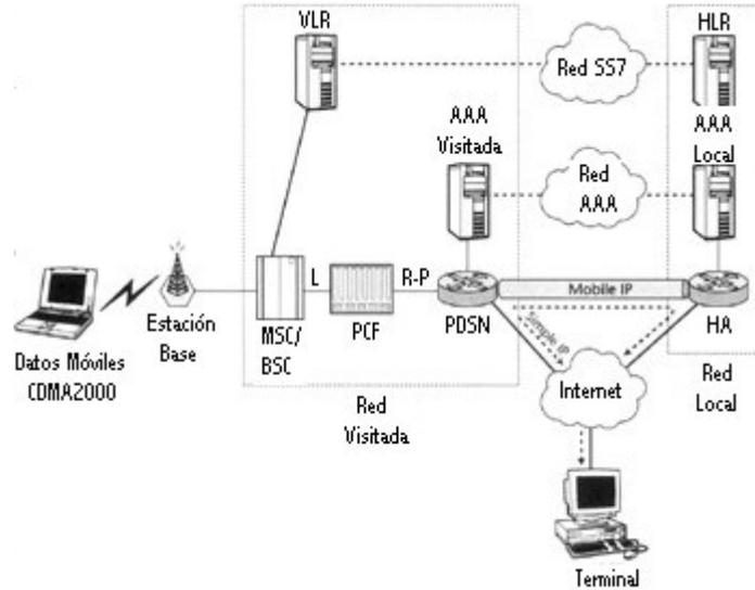
**Figura 4.6** Típica red central de CDMA2000 con subsistemas AAA
