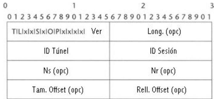
**Figura 2.2** Encabezado del mensaje de L2TP.
