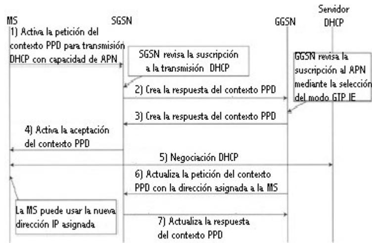
Figura 7.3 DHCPv4 en sistemas GPRS
