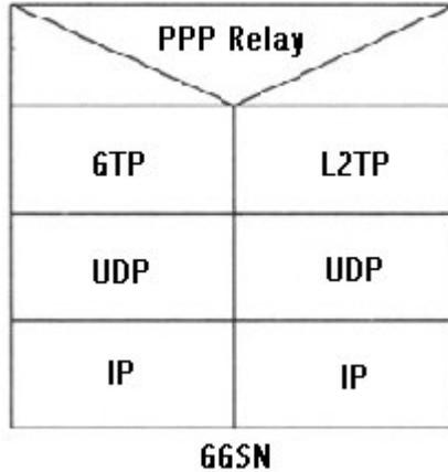
**Figura 7.4** PPP transmitido usando L2TP.
