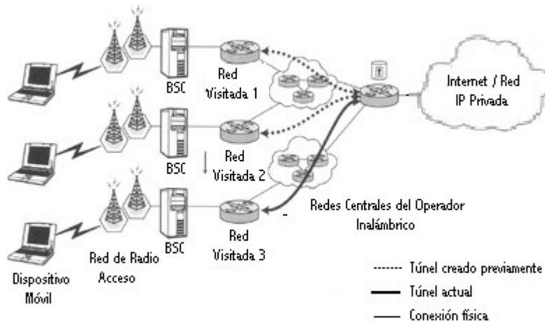
**Figura 4.1** Mecanismo de túneles para paquetes de datos inalámbricos.
