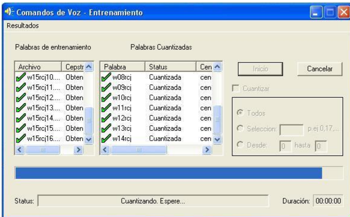
Fig. 4.3 Módulo de entrenamiento obteniendo los centroides de los comandos entrenados.
