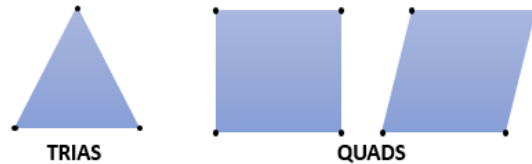
Fig.3.1. Geometrías más comunes que se adoptan para describir los subconjuntos o elemento finitos que conforman al sistema global.
