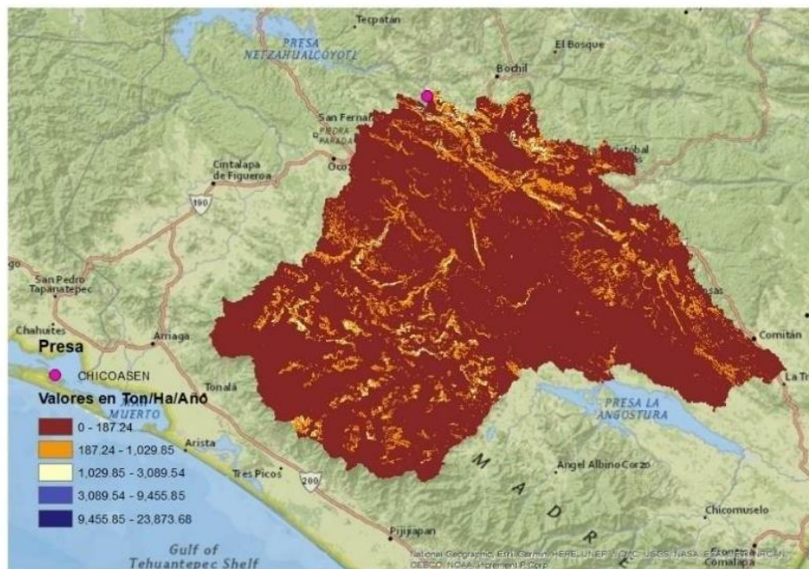
Figura 3.1.3 Valores de erosión de la cuenca Chicoasén. Fuente: creación propia con datos del INEGI
