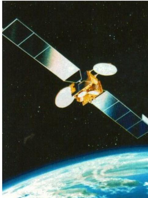
En la figura 1.6 se muestra un satélite de estabilización Triaxial,
