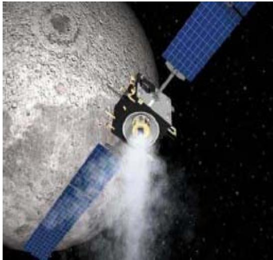
En la figura 3.23 puede verse la posición típica en que se coloca el propulsor LAM o de apogeo.
