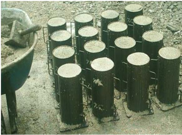
**Figura V.4 Curado de cilindros.**
