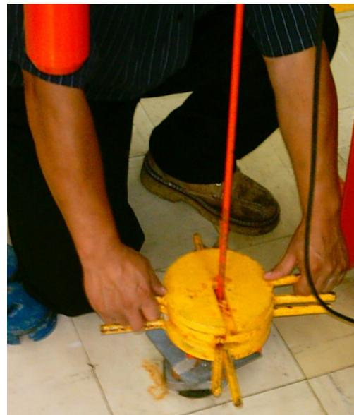
Figura 2.3.9 Colocación de pesas durante el ensaye
