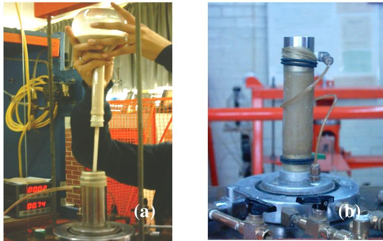
Figura 2.3.6 (a) llenado de probeta por decantación.
