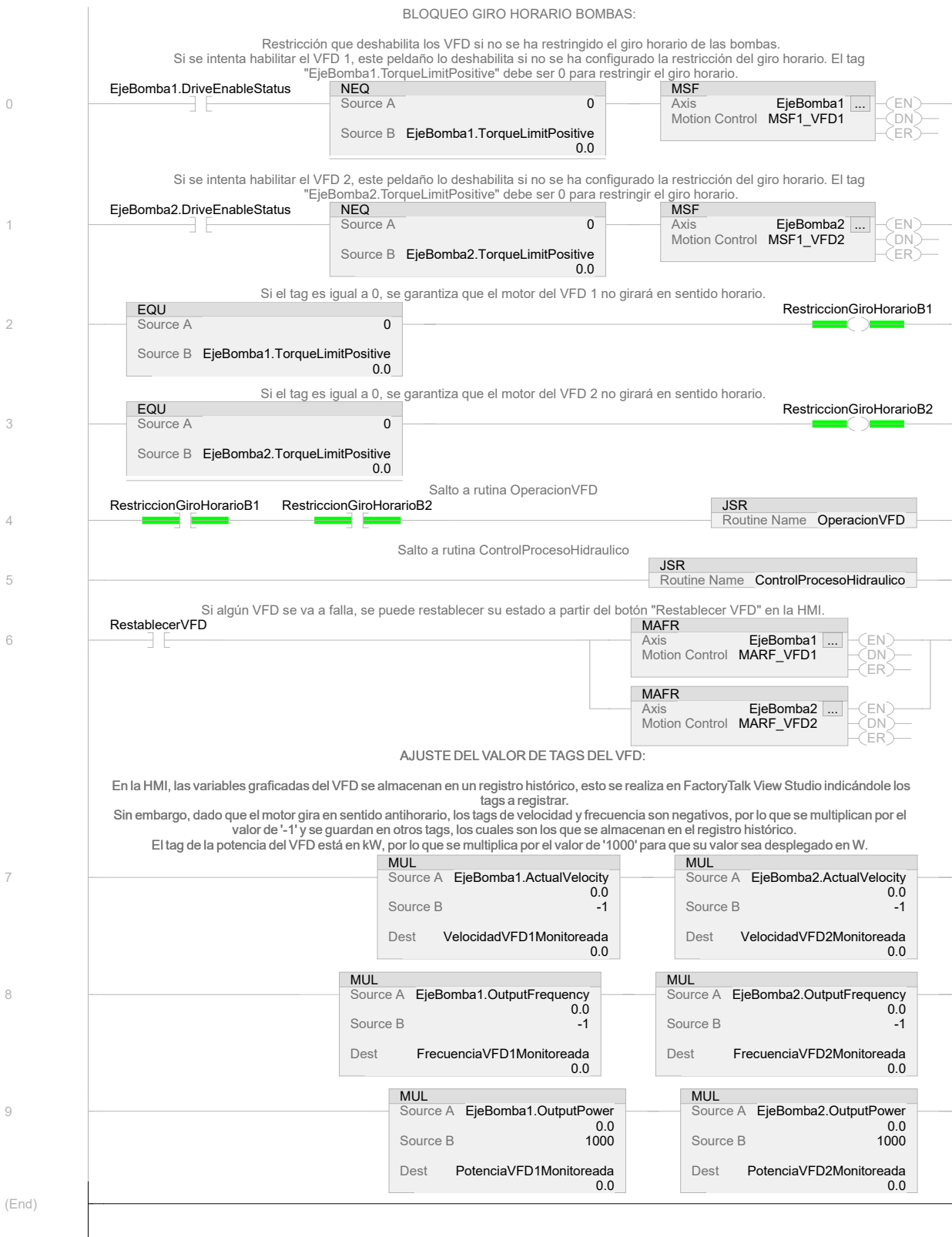
Figura 3.3 Rutina de control: Bloqueo giro horario bombas.
