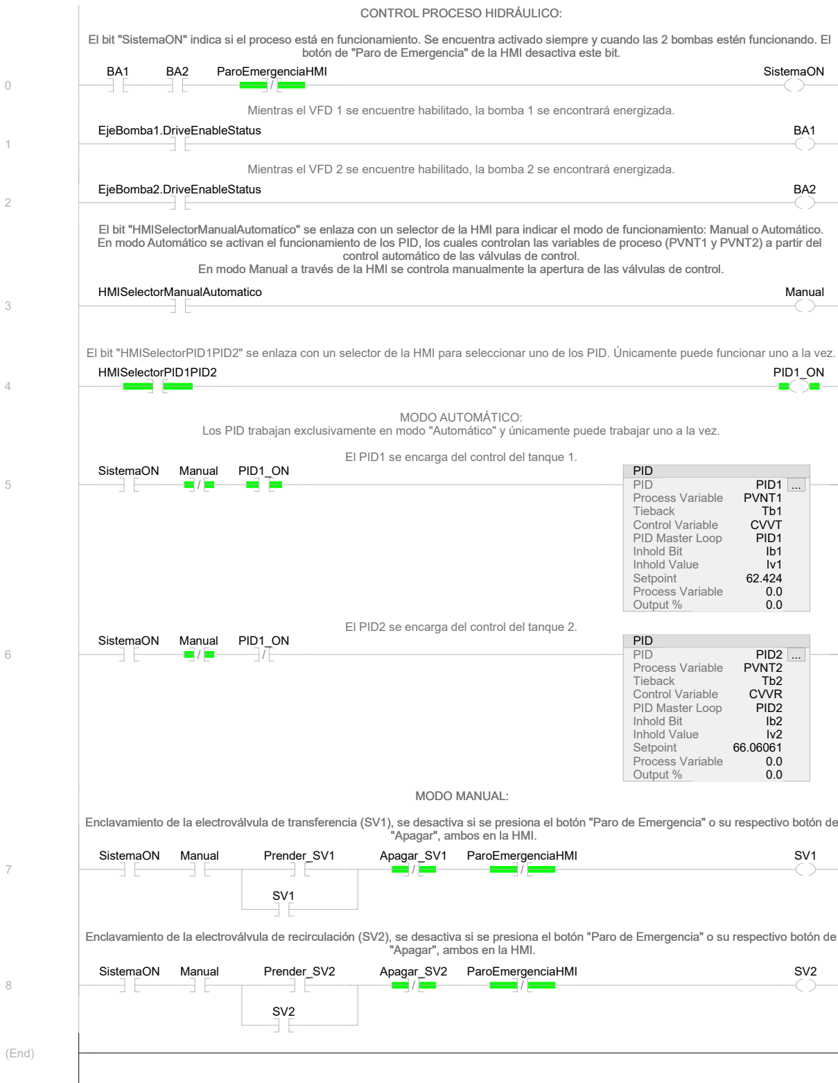
Figura 3.4 Rutina de control: Control proceso hidráulico.
