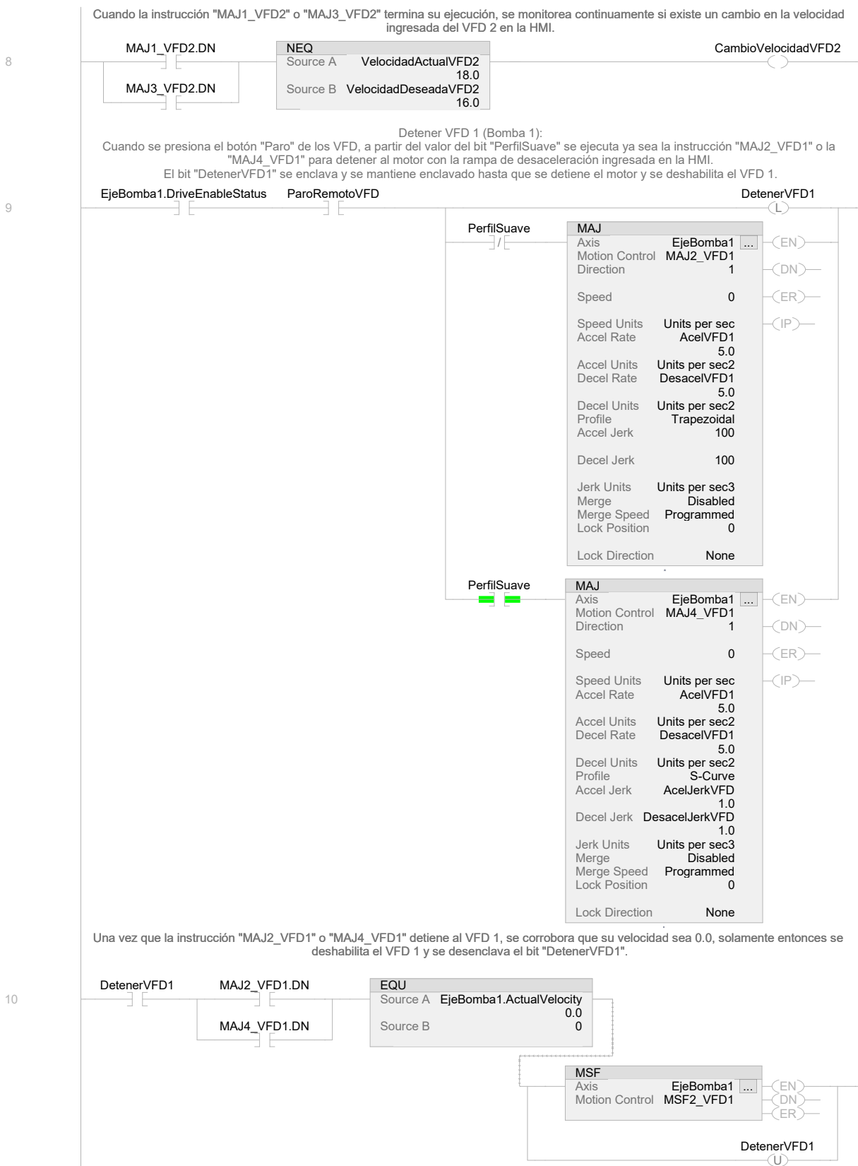
Figura 3.7 Rutina de control: Operación VFD 3 de 4.
