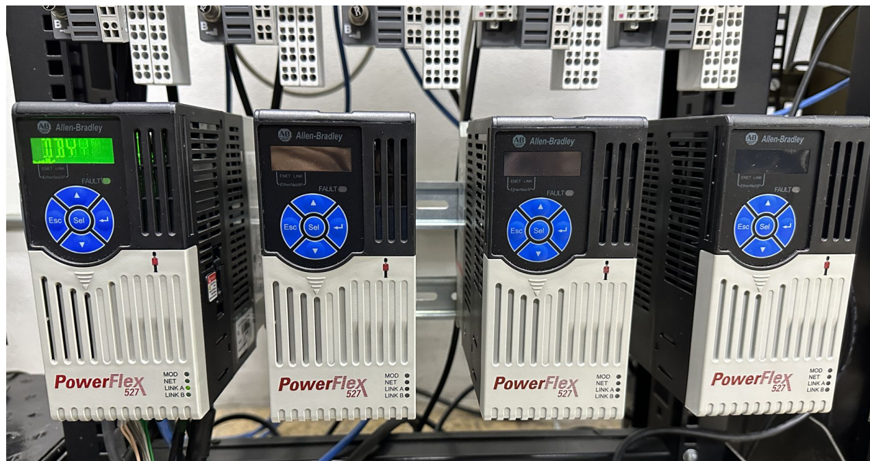
Figura 4.3 Variadores de frecuencia PowerFlex 527.
