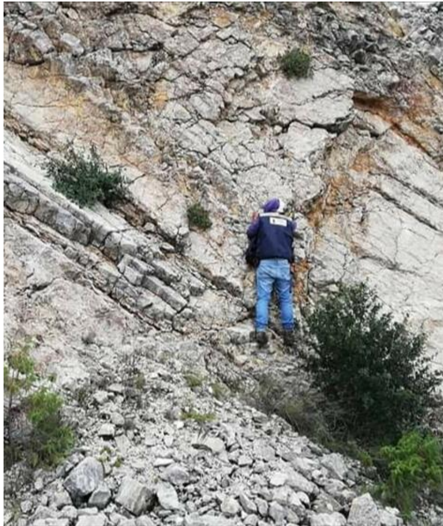
Figura 33. Fotografía de afloramiento de toma de datos estructurales mostrando planos de estratificación y fracturamiento. Sitio: Cantera Jonacapa
