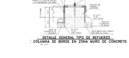
**DETALLE GENERAL TIPO DE REFUERZO: COLUMNA DE BORDE EN ZONA MURO DE CONCRETO**
