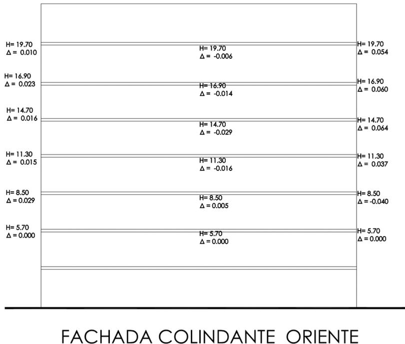
Figura 35. Medición topográfica fachada colindante oriente
