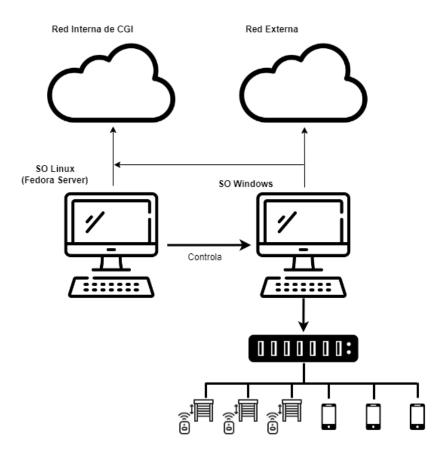
Diagrama 4. Diagrama conceptual de la instalación del servidor en Nogales.
