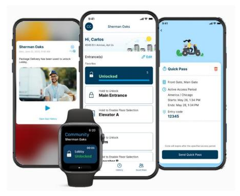
Figura 4. *myQ app* no solo permite la apertura y cierre de puertas de garaje de manera remota, sino que también permite controlar varias puertas en distintas ubicaciones, asignar pines de entrada temporales para invitados y para repartidores de paquetería. Todo desde un dispositivo móvil. [Fotografía], por *myQ*, S/F (Tomado de https://www.myq.com/community/community-manager).
