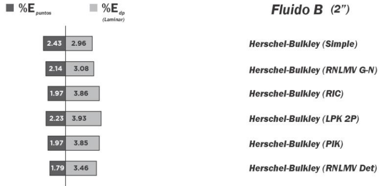
Figura 6. 8 Porcentaje de error de las ecuaciones de ajuste de curva (con el modelo de Herschel-Bulkley) y de los resultados de las pérdidas de presión por fricción para el fluido B [Cálculos realizados para el interior de la tubería de 2 [in], en flujo laminar y transición (Okafor y Evers, 1992)].
