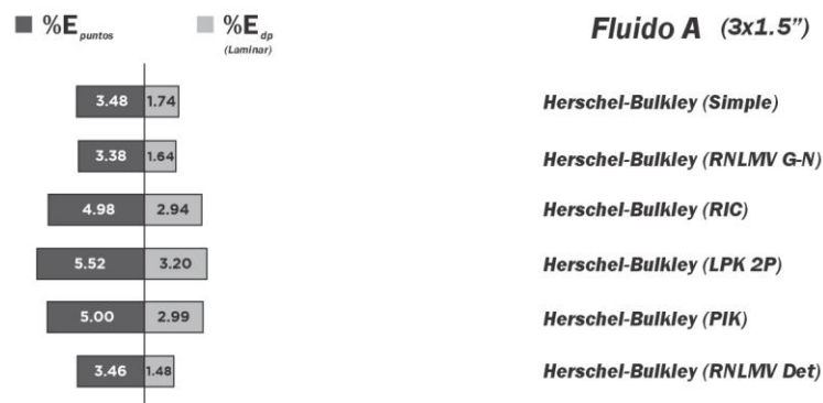
Figura 6. 5 Porcentaje de error de las ecuaciones de ajuste de curva (con el modelo de Herschel-Bulkley) y de los resultados de las pérdidas de presión por fricción para el fluido A.
