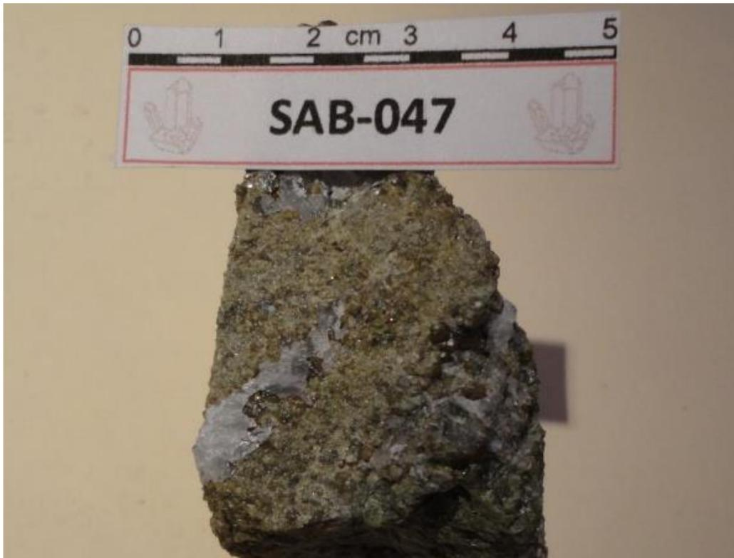
Figura 7.27 Muestra SAB-047 Skarn de color verde aceituna, de textura sacaroide deleznable, con grandes oquedades rellenas de calcita, menor cuarzo, calcopirita y planta nativa filiforme en microfracturas tardías.
