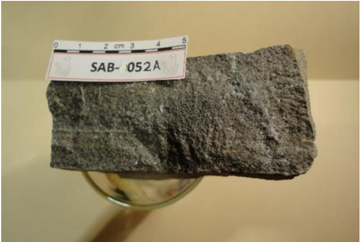
*Figura 7.9 Muestra SAB-052A de superficie, falda del Cerro Papantón. Roca masiva y compacta de color gris oscuro a pardo, bandeada con una evidente diferenciación granulométrica de grano medio a fino y con una estructura microbrechoide compuesta de abundantes fragmentos de pelíticos y otros relictos que se encuentran totalmente calcitizados, dentro de los cuales se reconoce plagioclasa.*
