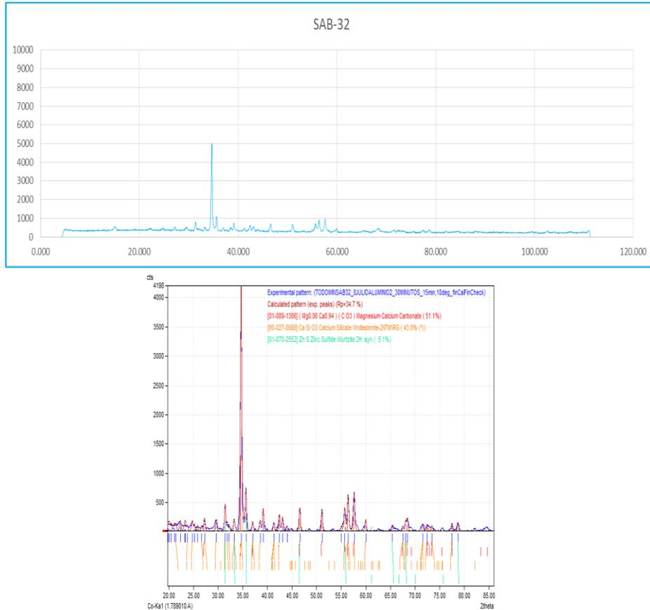
Figura 9.5 DRX Muestra SAB-032. El espectro de esta muestra presenta como mineral transparente dolomita (Ca,Mg)CO<sub>3</sub> en un 51%, Wollastonita en un 44% y esfalerita en un 5%, por ser un análisis semicuantitativo, se descarta de este análisis la esfalerita, sin embargo es presente al microscopio óptico. En esta muestra se confirma la presencia de wollastonita y dolomita, así como esfalerita libre de hierro.
