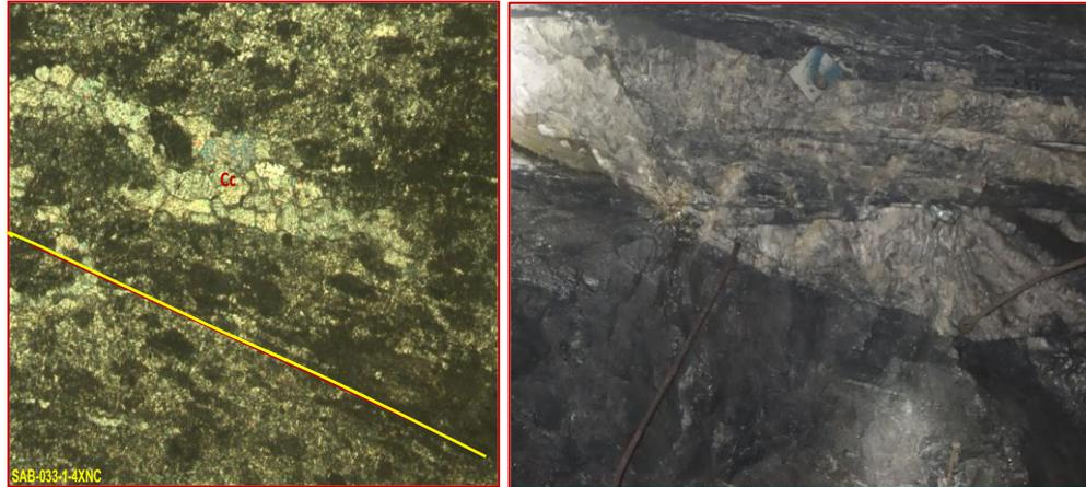
Figura 10.2 Megascópicamente el detalle de estructuras sigmoidales observadas en mina, también se ve reflejado microscópicamente, obsérvese un sigmoide con un relleno de calcita recrystalizada con puntos triple, siendo un mármol, por lo que cuando el sigmoide es hectométrico y de amplio espesor se puede confundir con una veta y sobre todo cuando contiene mineralización como es el caso de SAB-033.
