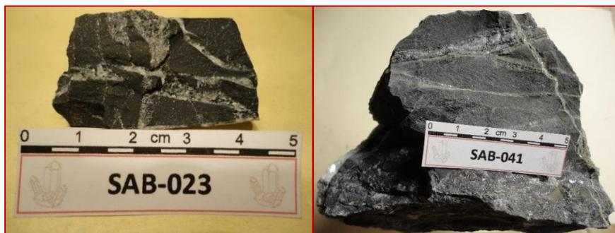
Figura 10.8 Estructuras de fracturamiento de extensión o deformación frágil, la muestra SAB-023 presenta en detalle el fracturamiento en el hornfels relleno de calcita bien cristalizada en textura de relleno de cavidades, así mismo se parecía la formación de brecha, mientras que en la muestra SAB-041 también en el hornfels, se observa el mismo tipo de fracturamiento pero además presenta un halo de silicificación en los bordes de las fracturas, lo que confirma un proceso de silicificación tardío.
