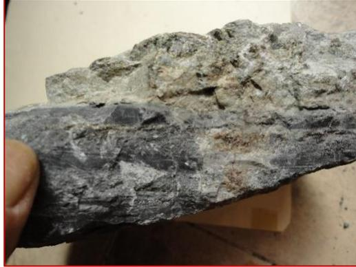
Figura 10.9 Estructuras de fracturamiento que pone en contacto al skarn y hornfels en la muestra SAB-046 evidencia que no todos los contactos del skarn son de forma transicional, sino que algunos se encuentran en contacto por fallamiento.
