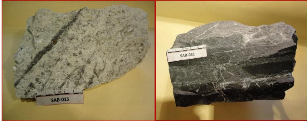
Figura 10.6 Estructuras de cizalla en intrusivo y hornfels en las muestras SAB-015 y SAB-031, en ambas muestras se observa un fallamiento semiparalelo, evidenciando el reflejo de una cizalla. El intrusivo presenta la estructura rellena de epidota y clorita asociadas principalmente a calcita y menor cuarzo. Mientras que el cizallamiento en el Hornfels se encuentra relleno de calcita, principalmente donde se aprecian dos etapas de deformación compresiva.
