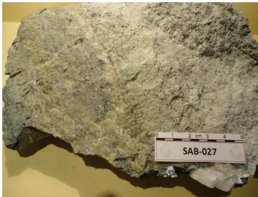
*Figura 7.23 Muestra SAB-027. Roca masiva de color gris blanco, con textura de grano muy fino, constituida principalmente por granate totalmente microcristalino, presenta fracturamiento relleno de calcita y puntos oscuros de mineralización y oquedades con cuarzo euهدral.*
