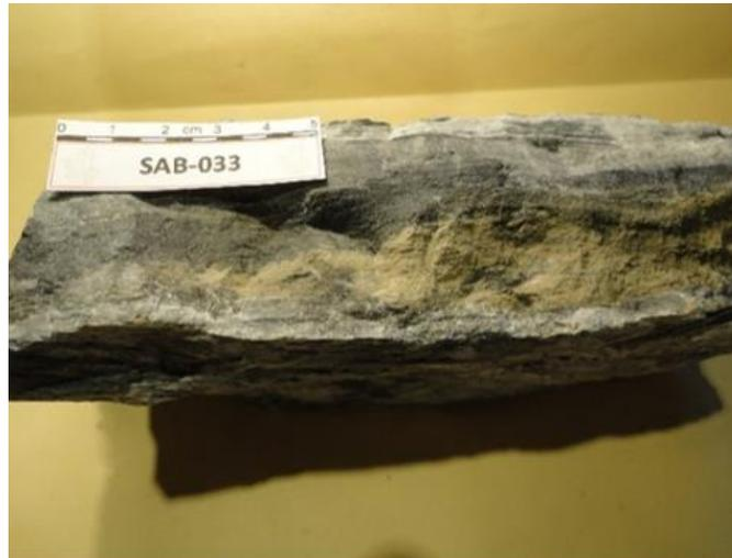
*Figura 7.7 Muestra SAB-033, Megascópicamente se observa una intercalación de niveles altamente arcillosos, intercalados con hornfels.*
