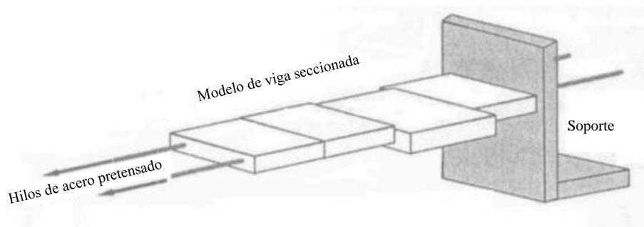
Figura 36. Modelo de banda tensada. Fuente: Geo [15]
