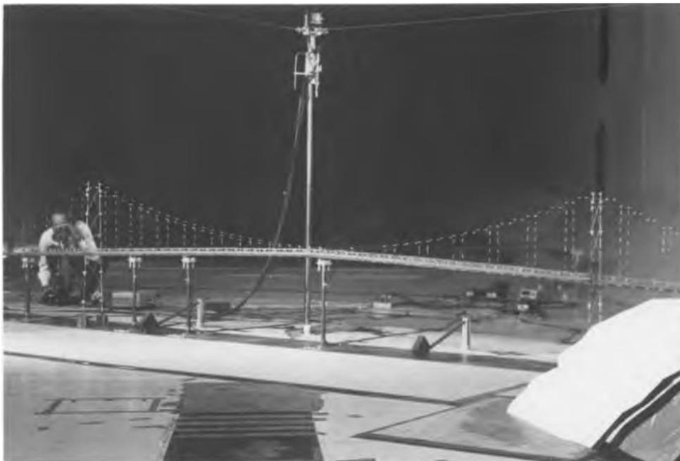
Figura 32. Modelo aerolástico del puente Lions' Gate, Vancouver. Fuente: Larsen [3]
