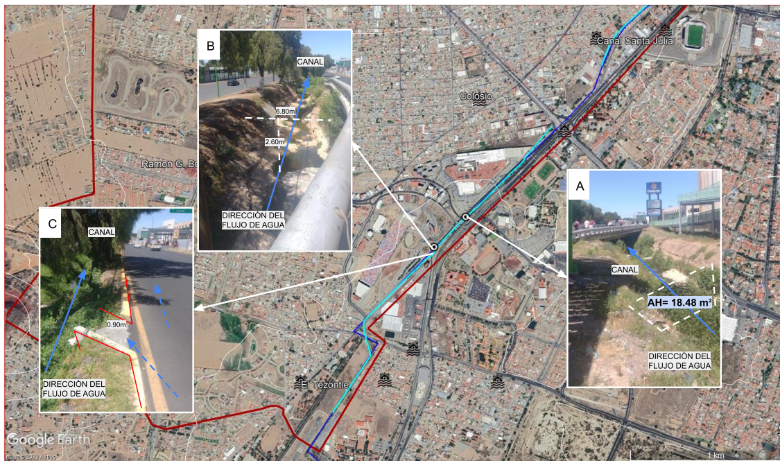
Figura 182. Imagen Satelital Google Earth con Red Hidrográfica Natural Fotografía A, B y C: condiciones del cauce continuo al canal de Santa Julia, a un lado del boulevard Felipe Ángeles.
