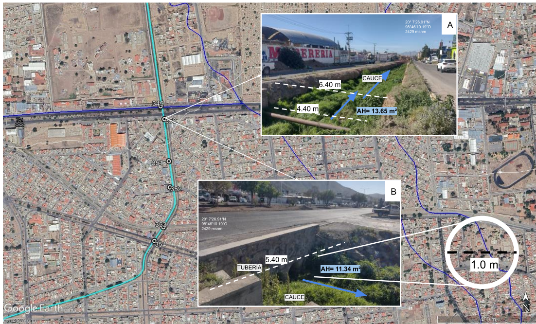
Figura 166. Imagen Satelital Google Earth con Red Hidrográfica Natural, Fotografías A y B: muestran las condiciones del afluente natural que pasa por las tuberías que se observan en la imagen B, y continua por canal con un área hidráulica de 11.34 metros cuadrados, además es importante resaltar que este canal capta gran parte del agua que escurre por el boulevard del Minero.
