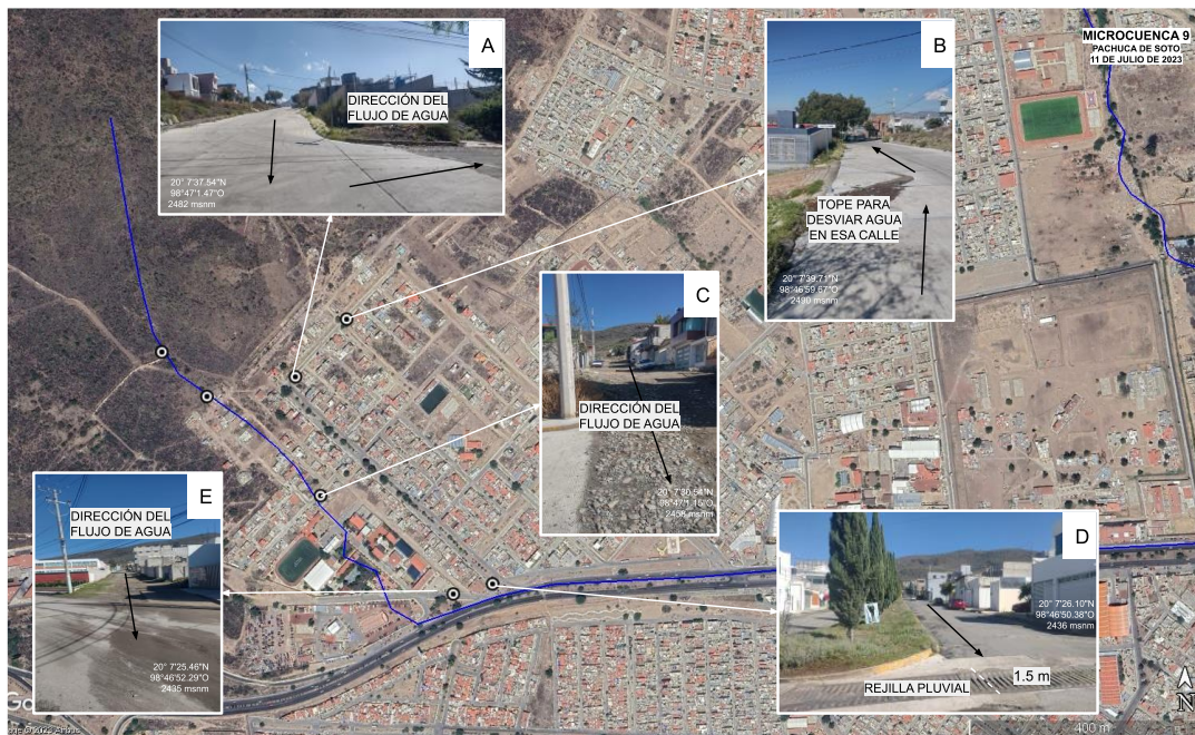
Figura 139. Imagen satelital Google Earth. A) Fotografía que muestra la dirección del flujo del agua en las calles al norte de la microcuenca. B) Fotografía donde se observa un tope que sirve para desviar la dirección del flujo en la calle. C, D y E) Fotografías con la dirección del flujo del agua con dirección norte-sur. D) Se muestra, además, una rejilla pluvial de 1.5 m de ancho, con las condiciones adecuadas para captar agua. Fotografías de la Colonia Campo de tiro en Pachuca de Soto.
