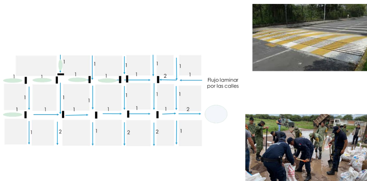
Figura 186. Ejemplo de colocación de topes y costales para desviar el agua de la ZRI.
