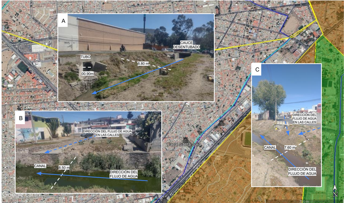
Figura 181. Imagen Satelital Google Earth con Red Hidrográfica Natural Fotografía A: en esta fotografía se observan más tuberías del sistema de drenaje que desemboca a este canal. Fotografías B y C: se observa la dirección del flujo del canal y la dirección del flujo que aportan las calles a este canal.
