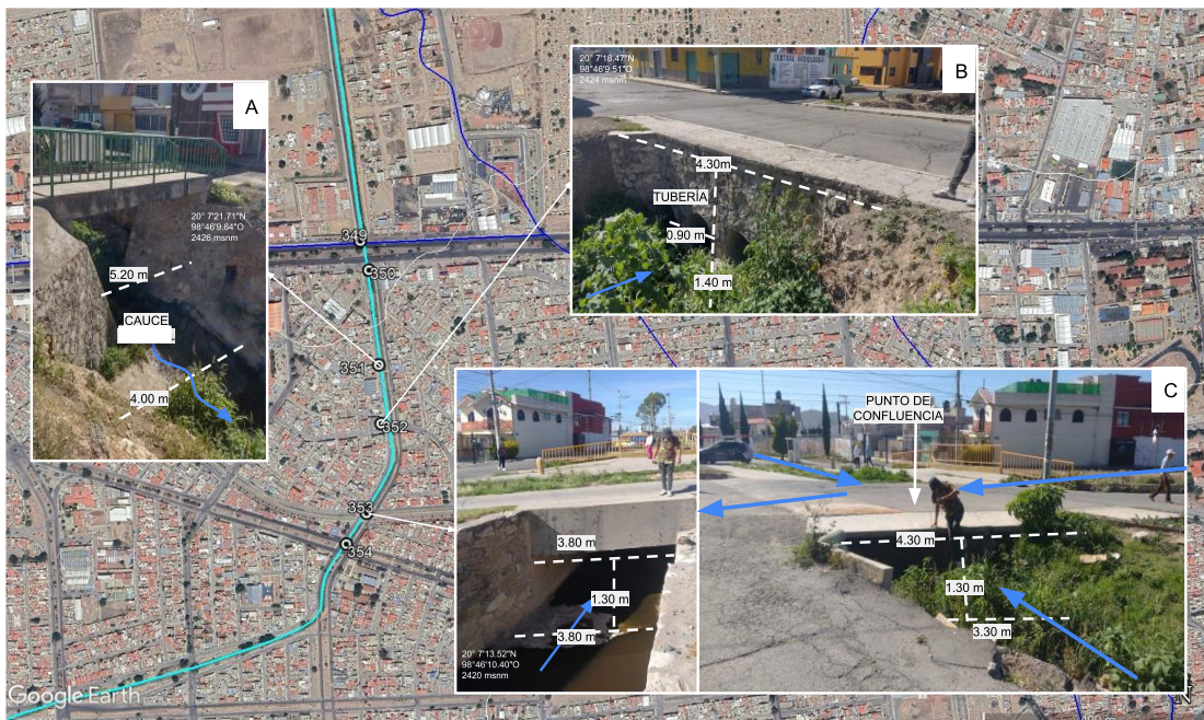
Figura 166. Imagen Satelital Google Earth con Red Hidrográfica Natural, Fotografías A y B: muestran las condiciones del afluente natural que pasa por las tuberías que se observan en la imagen B, y continua por canal con un área hidráulica de 11.34 metros cuadrados, además es importante resaltar que este canal capta gran parte del agua que escurre por el boulevard del Minero.
