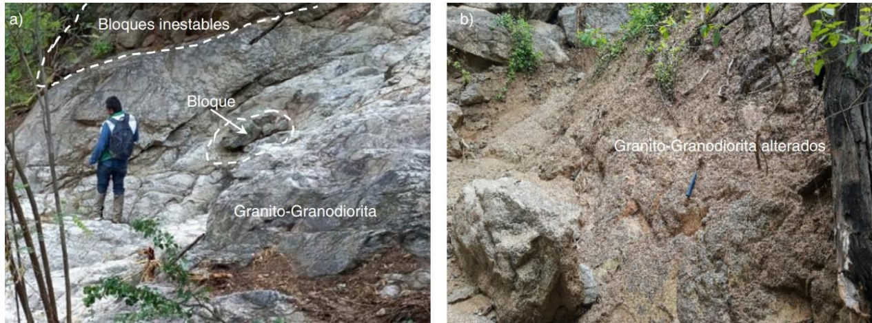
Fotografía 7. a) Afloramiento de granito-granodiorita de color gris claro, masivo y moderadamente fracturado, lo que ocasiona la formación de bloques inestables. b) Granito-granodiorita de color pardo con tonalidad ocre, afectada por un grado de alteración medio y fácilmente deleznable con la pica.
