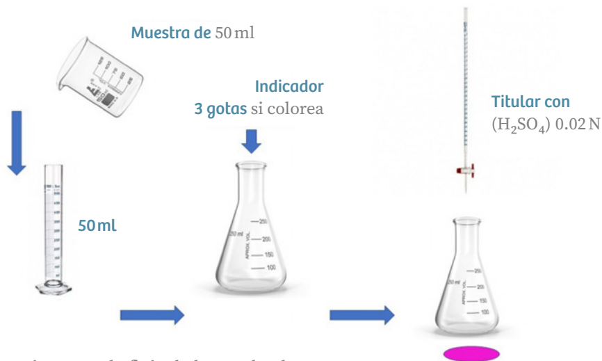
Figura 1.21 Diagrama de flujo de la Prueba de Alcalinidad. (Fundación Nacional de Salud 2013).
