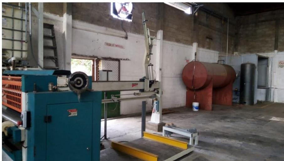
Figura 25: Brazo automático de alimentación totalmente instalado . (Archivo propio)
