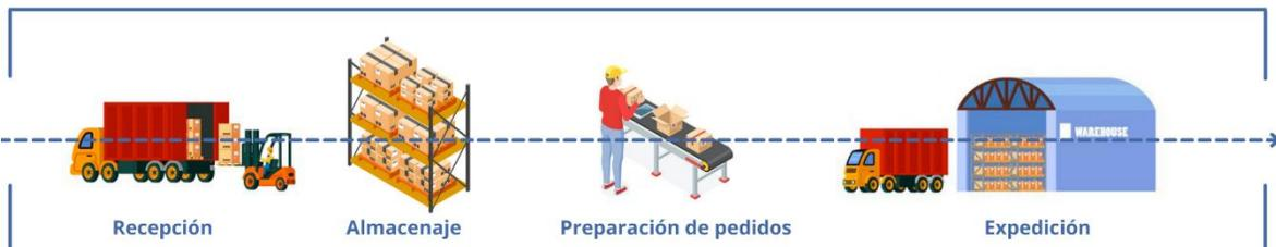
Figura 7. Esquemización de flujo en línea recta. (Fuente. [https://www.polypal.com/.](https://www.polypal.com/))
