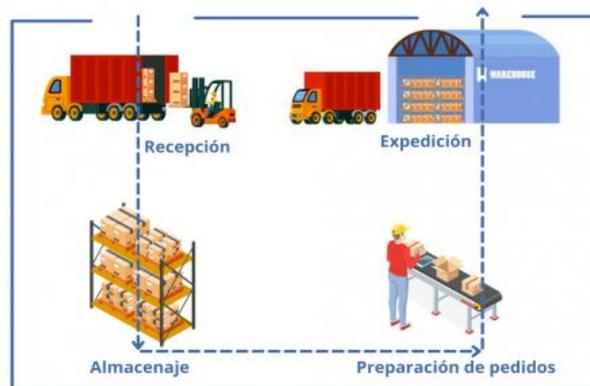
Figura 5. Esquematación de flujo en forma de U o Herradura. (Fuente. <https://www.polypal.com/>)
