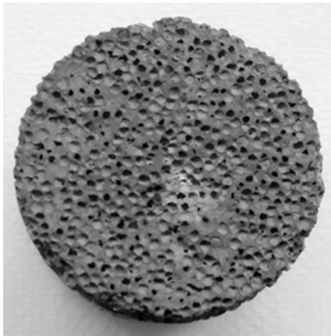
Figura 3. Espuma de titanio obtenida por proceso de ESC [1]
