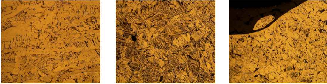
Figura 23. Microestructuras 100x a) Zona inferior; b) Zona media; c) Zona superior
