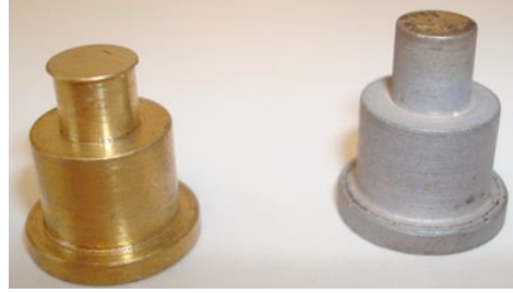
Figura 7. Condición de muestras de latón antes y después del proceso de tratamiento de difusión de zinc [10]
