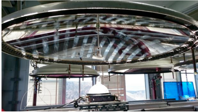
Figura 9. Disposición de experimento en horno solar vertical, para obtener un biomaterial compatible con tejido óseo; obsérvese la cámara experimental de atmósfera controlada [16]
