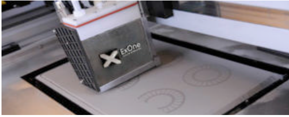
Figura 9. Cabezal de impresión, máquina ExOne's 3DP Figura 10. Pieza por inyección de adhesivos
