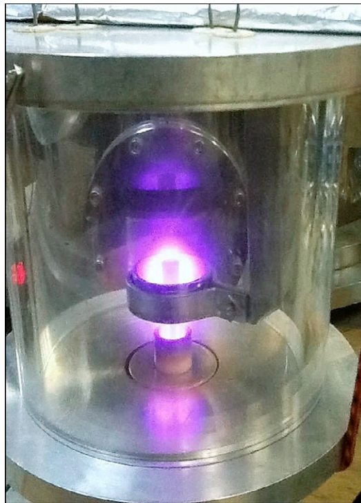
Figura 10. Observación del plasma generado en un equipo de nitruración iónica de una fundición nodular [21].
