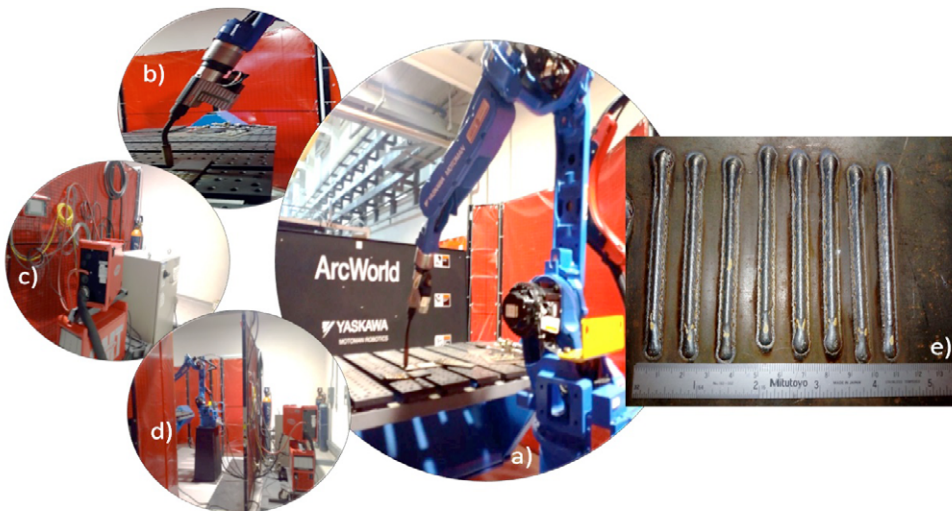
Figura 3. Fotografías que muestran: a) celda robotizada para proceso de soldadura CMT®, b) acercamiento de la antorcha, posicionador y mampara, c) equipo de soldadura CMT® y fuente de potencia, d) vista de mamparas protectoras, y e) ejemplo de cordones depositados.
