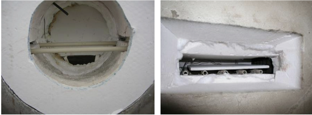
Figura 8. Cámaras termosolares para procesamiento de materiales cerámicos para muestras “pequeñas” y “medianas” [7].
