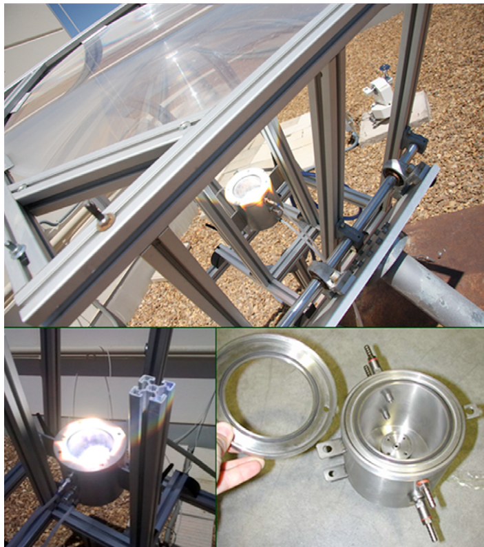
Figura 2. Concentrador con lente de Fresnel, instrumentado para sinterizado de aceros rápidos [9]
