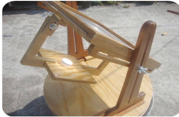
Figura 5. Prototipo de un concentrador que emplea una lente de Fresnel para investigación en manufactura (i.e. soldaduras, sinterización); de la Facultad de Ingeniería, UNAM [5]
