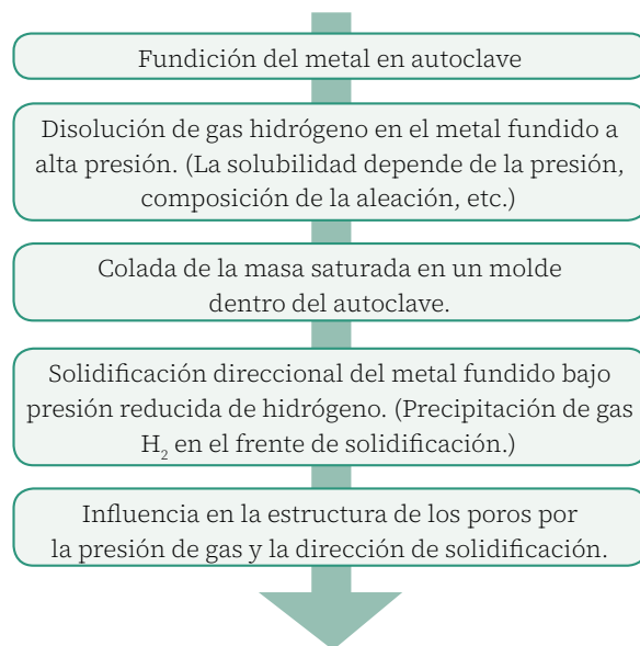
Figura 10. Espumado de metales por el método GASAR [28]
