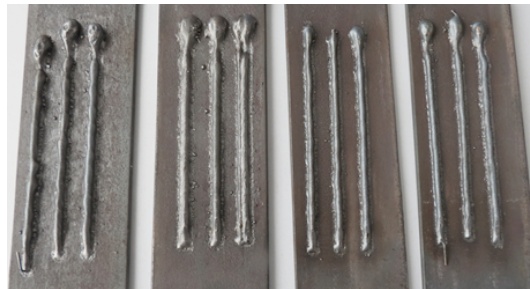
Figura 15. Pruebas preliminares para determinar parámetros en el proceso de manufactura aditiva
