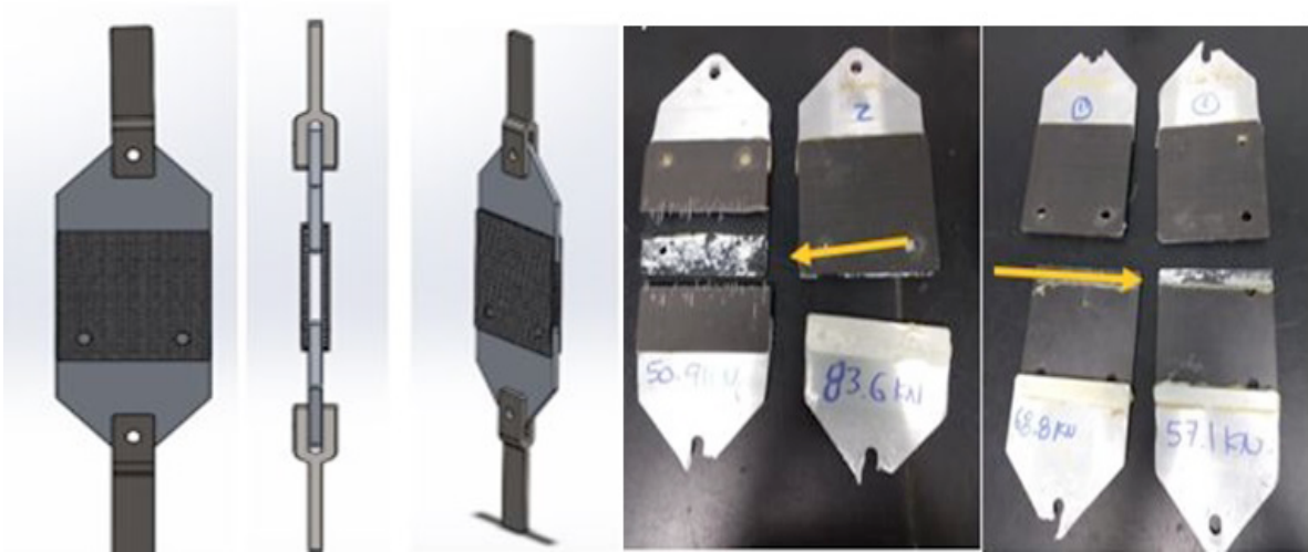
Figura 23. Configuración del ensayo y probetas de unión con falla [50]
