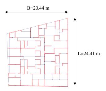
Gráfico 2-3 Planta tipo del edificio, cumple con ser una planta no alargada
