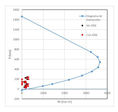
Gráfico 5-6 Resultados del diseño a flexo-compresión para el muro más desfavorable sin y con IDSE
