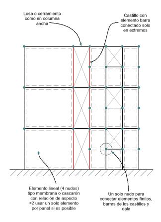
Gráfico 5-5 Modelo de muro con elementos finitos (NTC-DM, 2020)
