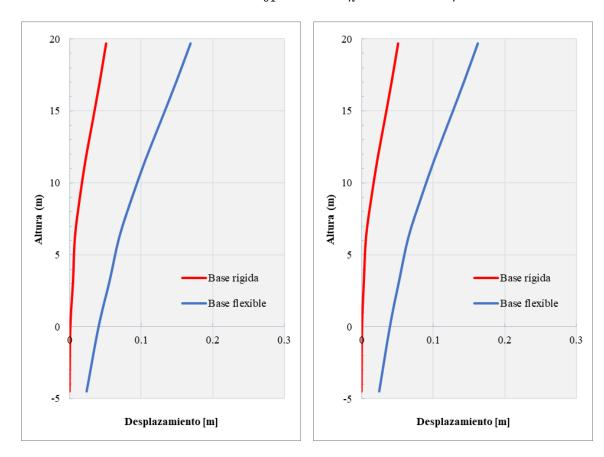
Gráfico 5-3 Desplazamientos laterales en dirección X (izquierda) y Y (derecha)
