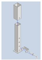
Figura 3.2 Ensamble del soporte regulador de altura.
