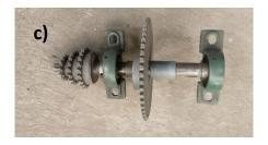
Figura 2.19 a) Eje principal. b) Cortador del peletizado en caliente. c) Eje secundario.
