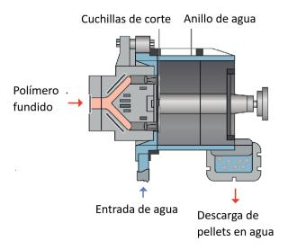
Figura 1.10 Máquina de peletizado de anillo de agua. [9]
