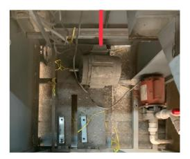
Figura 2.14 Soporte del sistema motriz desprendido.
