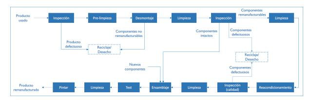
Figura 1.5 Estructura general del proceso de remanufactura. [7]
