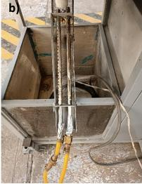
Figura 3.26 a) Sistema de descarga de peletizado en caliente montado. b) Sopladores en el sistema de descarga.
