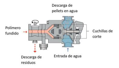
Figura 1.11 Máquina de peletizado bajo agua. [9]
