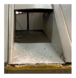
Figura 2.12 Descarga de material ineficiente.
