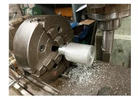
Figura 3.33 Fabricación del rodillo inferior.
