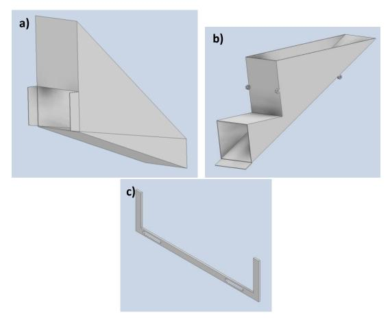
Figura 3.11 Modelos sólidos 3D para la solución de fuga de material. a) modificación del sistema de descarga inferior. b) modificación para el sistema de descarga superior. c) rieles para movilidad del sistema de descarga superior.
