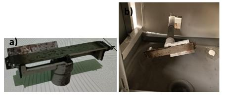
Figura 3.55 a) Cortador del peletizado el caliente refabricado. b) Cortador del peletizado en caliente montado.
