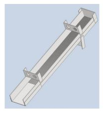
Figura 3.24 Aditamentos a la rampa de descarga del peletizado en caliente.
