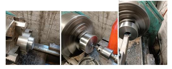
Figura 3.51 Maquinado en torno del cortador giratorio.
