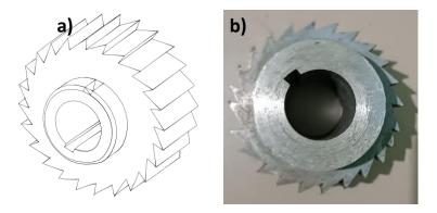
Figura 2.9 a) Diseño documentado del cortador b) cortador manufacturado con errores.
