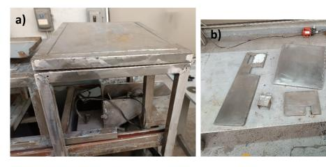
Figura 3.42 a) Estructura fija reparada y despintada. b) Piezas de lámina retiradas de la estructura fija para su reparación individual.
