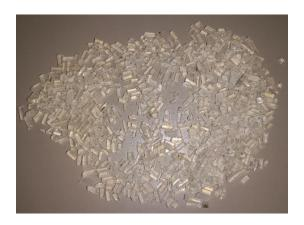
Figura 4.8 Muestra de pellets de PLA.
