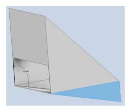
Figura 3.15 Modelo sólido 3D de cambio de ángulo en el sistema de descarga inferior.
