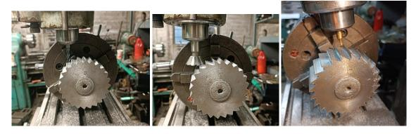
Figura 3.52 Maquinado en fresadora del cortador giratorio.
