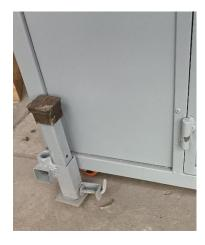
Figura 3.7 a) Soporte regulador de altura montado en la máquina. b) Estado final de soporte regulador de altura.
