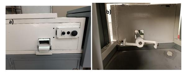
Figura 3.46 a) Modificación de la tapa frontal de la unidad móvil. b) Tapa aislante entre los dos sistemas de peletizado.
