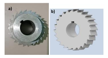
Figura 3.49 a) Cortador original. b) Modelo sólido 3D del cortador modificado.
