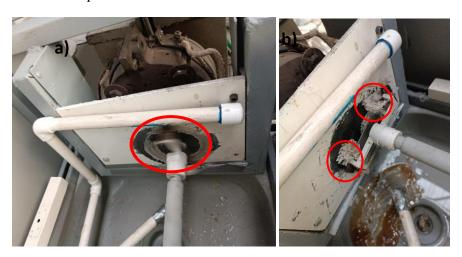
Figura 4.13 Defectos en el peletizado en caliente.
