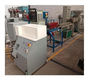
Figura 4.1 Línea de producción de peletizado en frío.
