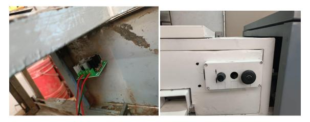
Figura 3.41 a) Circuito variador de frecuencia PWM. b) Botonera de control para el sistema de alimentación.
