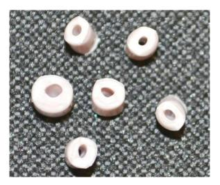
Figura 1.15 vacíos en pellets. [18]
