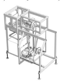
Figura 2.1 Estructura de la máquina peletizadora dual. [25]
