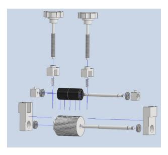
Figura 3.28 Explosivo del modelo del sistema de alimentación.
