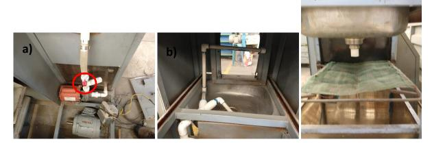
Figura 2.22 Sistema de enfriamiento. a) boba de agua. b) sistema de spray. c) sistema de descarga
