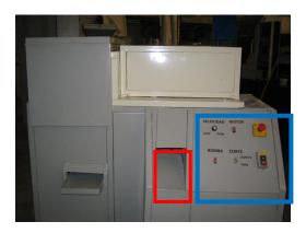
Figura 2.3 Panel de control (azul) y descarga de material (rojo). [25]
