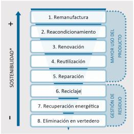
Figura 1.1 Procesos de recuperación en la remanufacturan. [4]
