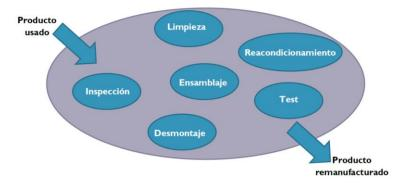
Figura 1.4 Etapas del proceso de remanufactura. [7]
