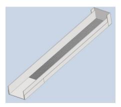
Figura 3.23 Modelo sólido 3D de la rampa de descarga del peletizado en caliente.
