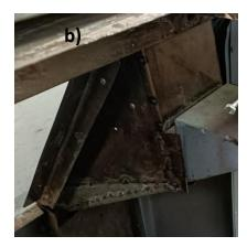
Figura 3.17 Fabricación del cambio de ángulo en la rampa inferior. a) base de la rampa desmontada. b) resultado del cambio de ángulo.
