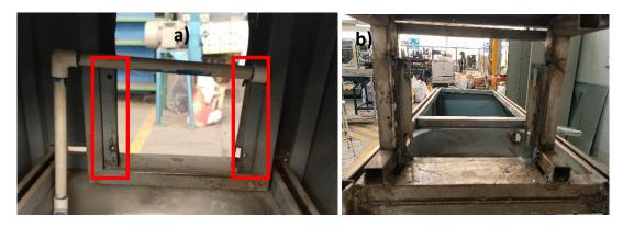
Figura 3.8 8 Modificación del acoplamiento con la extrusora. a) previo a modificarse. b) después de modificarse.
