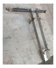
Figura 3.25 Rampa del sistema de descargar del peletizado en caliente.
