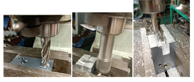
Figura 3.31 Fabricación de bases del sistema de alimentación.
