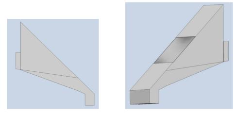
Figura 3.18 Modelo sólido 3D de extensión de la rampa de salida de material.
