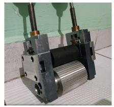
Figura 3.36 Sistema de alimentación ensamblado.
