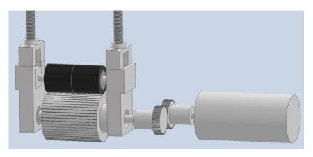
Figura 3.29 Diseño del modo de impulsión del sistema de alimentación.
