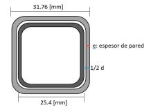
Figura 3.3 Diagrama del espacio entre perfiles tubulares.
