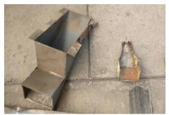
Figura 2.17 Sistema de descarga superior y sistema de alimentación.
