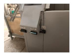
Figura 3.20 Sistema de descarga inferior con salida de material modificada.
