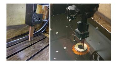
Figura 3.53 Maquinado del cuñero por electroerosión.
