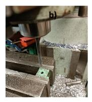
Figura 3.5 fabricación de soportes reguladores de altura. a) maquinado de PTR exterior. b) maquinado de soporte de perno.
