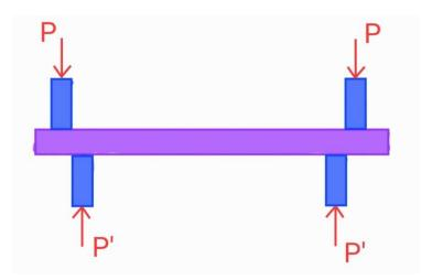
Figura 3.4 Diagrama de fuerzas que actúan sobre el perno de fijación.
