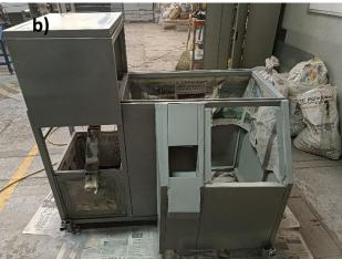
Figura 3.44 Trabajo de pintado en la estructura fija. a) Capa de pintura primaria. b) Capa de pintura acrílica.
