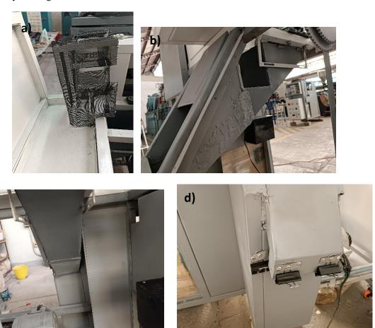
Figura 3.22 Modificaciones al sistema de recolección y descarga. a) Sistema de recolección. b) Unión entre sistemas de descarga. c) Sistema de descarga inferior. d) Salida de material.
