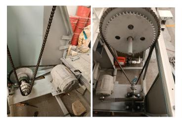
Figura 3.60 Resultado final del sistema motriz.
