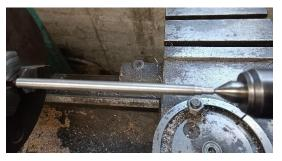
Figura 3.32 Fabricación de ejes del sistema de alimentación.
