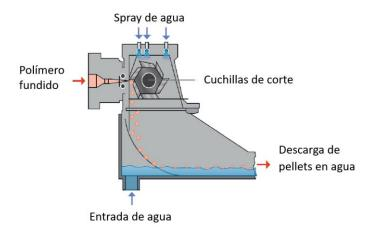
Figura 1.9 Máquina de peletizado con spray de agua. [9]
