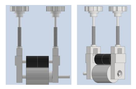
Figura 3.27 Diseño de concepto para el sistema de alimentación.
