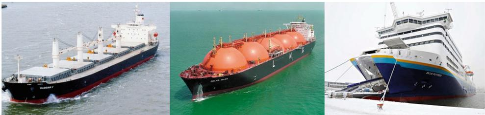
Figura 1.7: Granelero, carguero de gas natural, barco RO-RO (Roll On-Roll Off), de izquierda a derecha [12].
