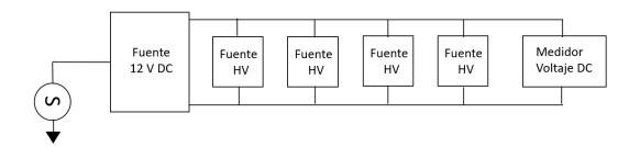
Figura 4.8 Diagrama de conexión fuente conmutada - 4 módulos de HV - medidor
