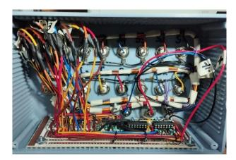
Figura 4.38 Modulo de inversores individuales alambrado
