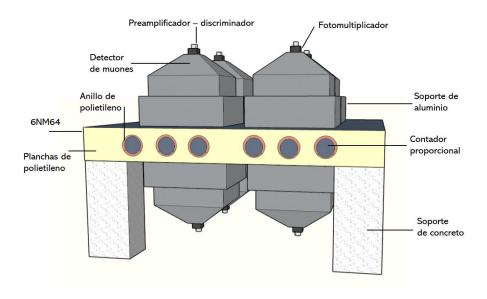
Figura 3.1 Diagrama del TM-CDMX y 6NM64
