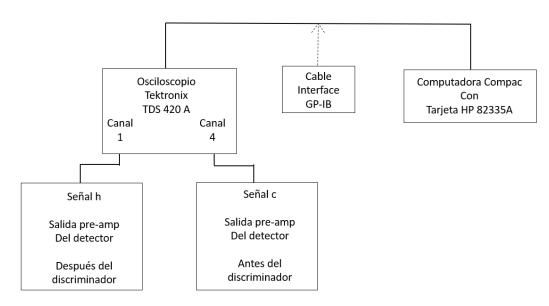
Figura 4.25 Diagrama instrumental para obtención de espectros de energía
