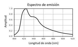
Figura 3.3 Espectro de emisión del plástico centellador utilizado [30]
