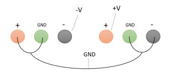
Figura 4.9 Diagrama de puentes de la fuente de BV
