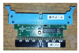
Figura 5.3 Adaptador tarjeta PCI
