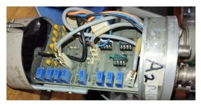
Figura 4.23 Foto del preamplificador – discriminador.
