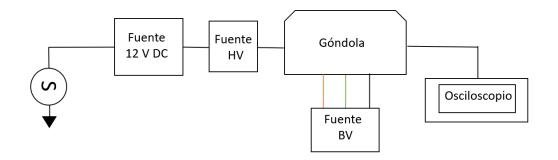
Figura 4.10 Diagrama de conexiones de cada detector
