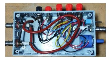
Figura 4.4 Interior de la Fuente de HV
