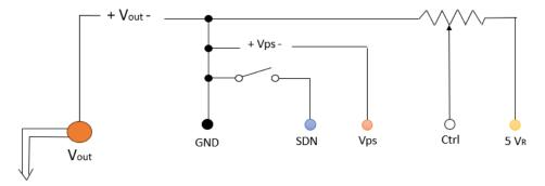
Figura 4.2 Diagrama Fuente HV
