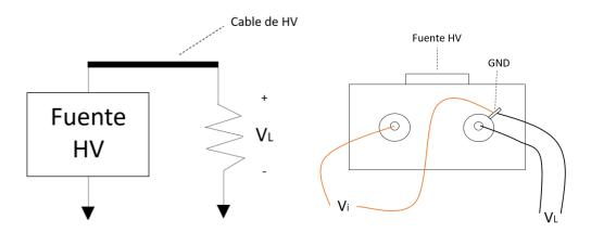
Figura 4.7 Conexiones para probar cables de HV
