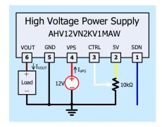
Figura 4.3 Conexiones Fuente HV [32]
