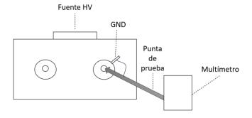
Figura 4.6 Conexión para probar fuentes HV
