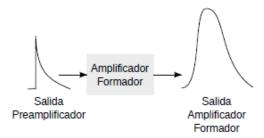
Figura 5.6 Funcionamiento amplificador formador [26]
