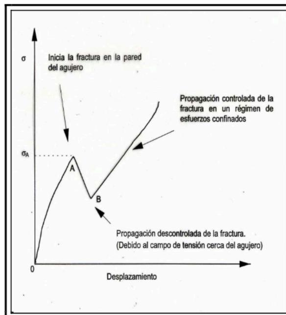
FIG. IV.16 Curva de esfuerzo-desplazamiento obtenida en una prueba de anillo modificado
