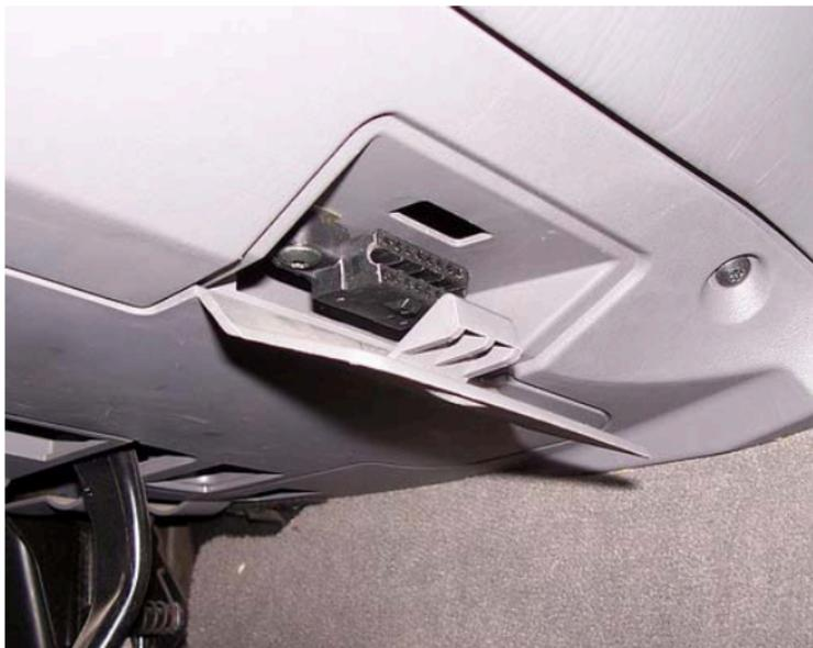
Figura 13. Localización del conector OBD en un Saab 9-5.
