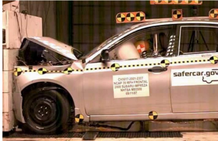
Figura 2. Prueba de choque frontal.
