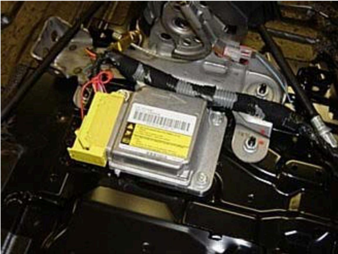
Figura 18. Sistema de GM *Delphi Air Bag SDM ‘black box’ EDR module*.
