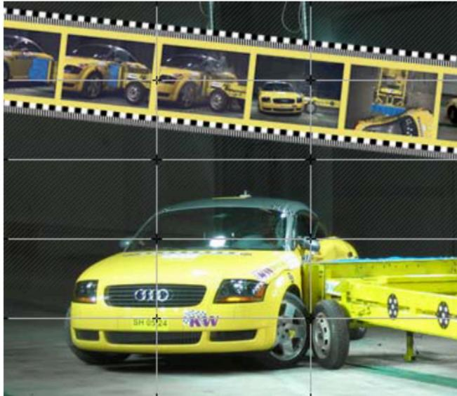
Figura 3. Prueba de choque lateral.
