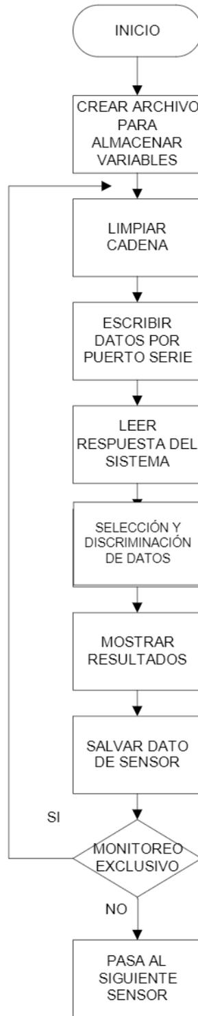
Figura 29. Diagrama de flujo para monitorear sensores.
