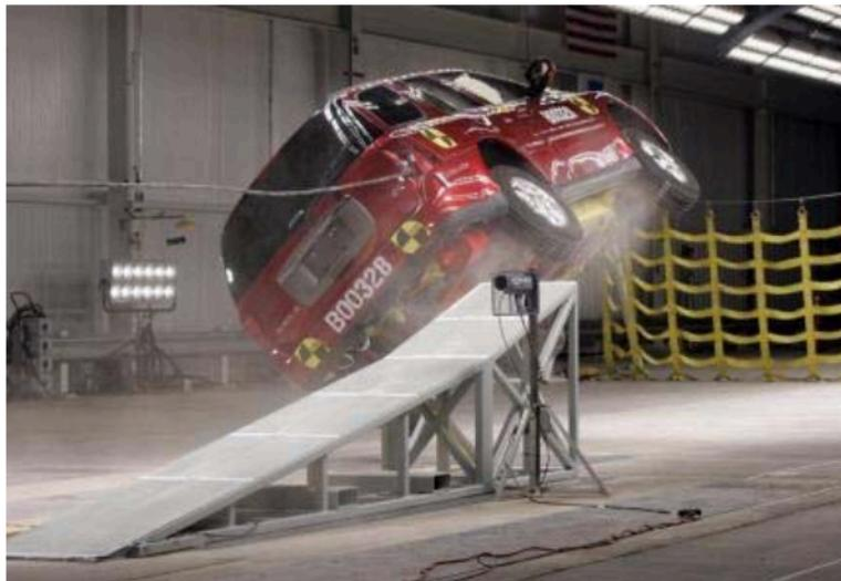
Figura 4. Prueba de volcadura.
