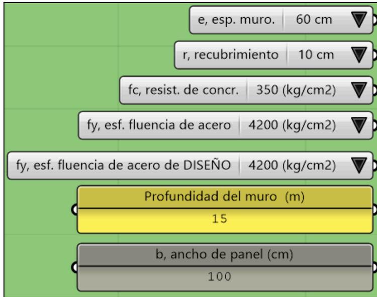
Figura 42. Propiedades de muro pantalla para prueba 2.
