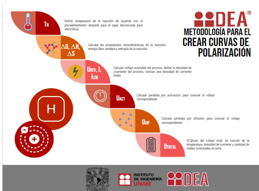
**Figura 37 Metodología para la creación de curvas de polarización a partir del cálculo de pérdidas de voltaje**
