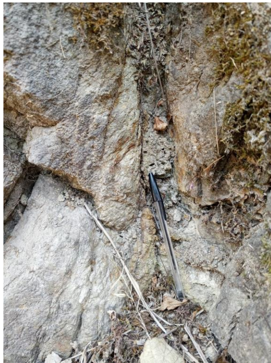
Figura 25. Fractura de cizalla con presencia de roca molida; 4 Dinamo (coordenadas: 14 Q 469302 E, 2130477 N).
