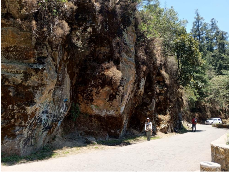
Figura 24. Fracturas extensionales en lava dacítica, 4 Dinamo (coordenadas: 14 Q 469302 E, 2130477 N).
