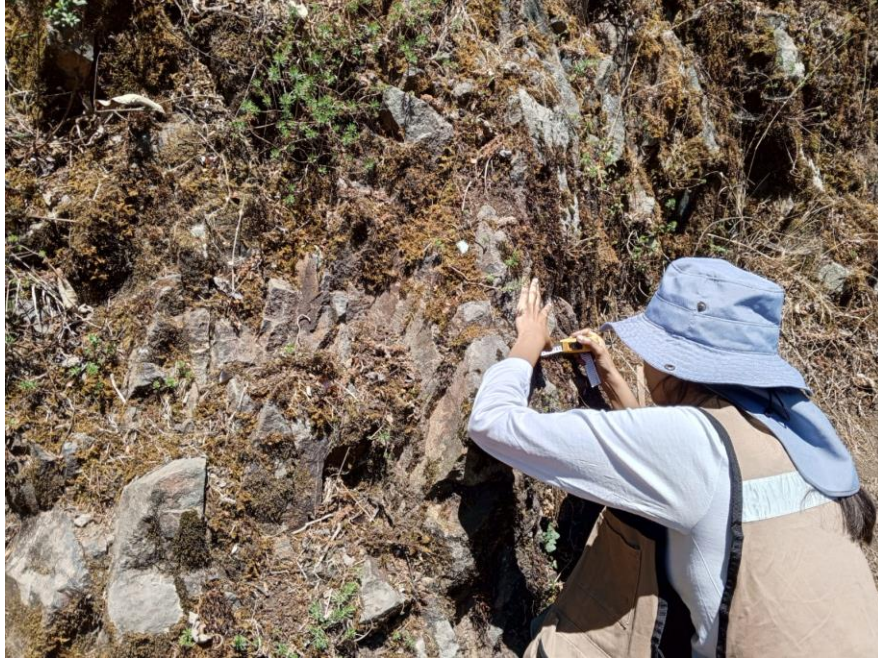
Figura 15. Toma de datos de apertura en rocas volcánicas dacíticas que se exponen sobre la carretera cerca del 4 Dinamo (coordenadas: 14 Q 469302 E, 2130477 N).
