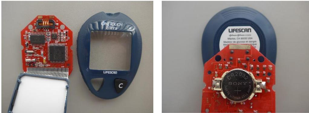
Figura 6: Observación de los componentes principales en el glucómetro One Touch Ultra
