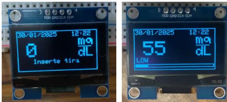
Figura 17: Interfaz final del glucómetro
