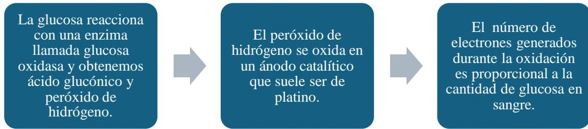
Figura 7: ¿Cómo funciona el método amperimétrico?
