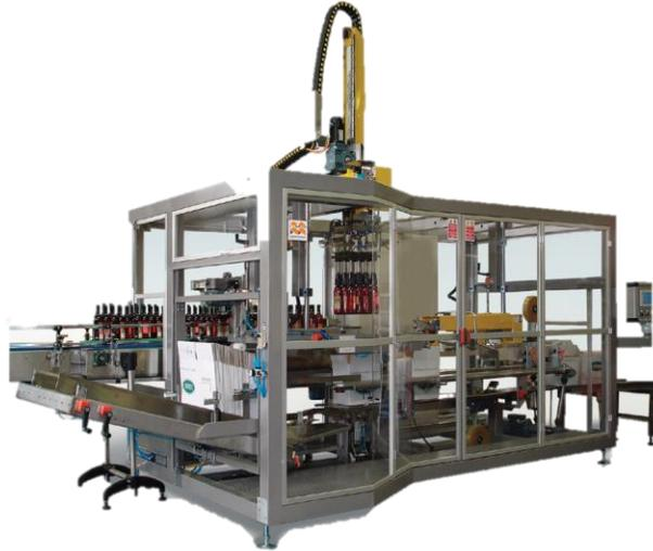
*Figura 19. Ejemplo de empacadora de botellas*
