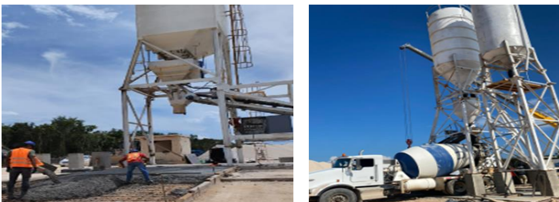
Figura No. 3.1 Muestreo de concreto en Planta Premezcladora. Ref. 16 El Autor.
