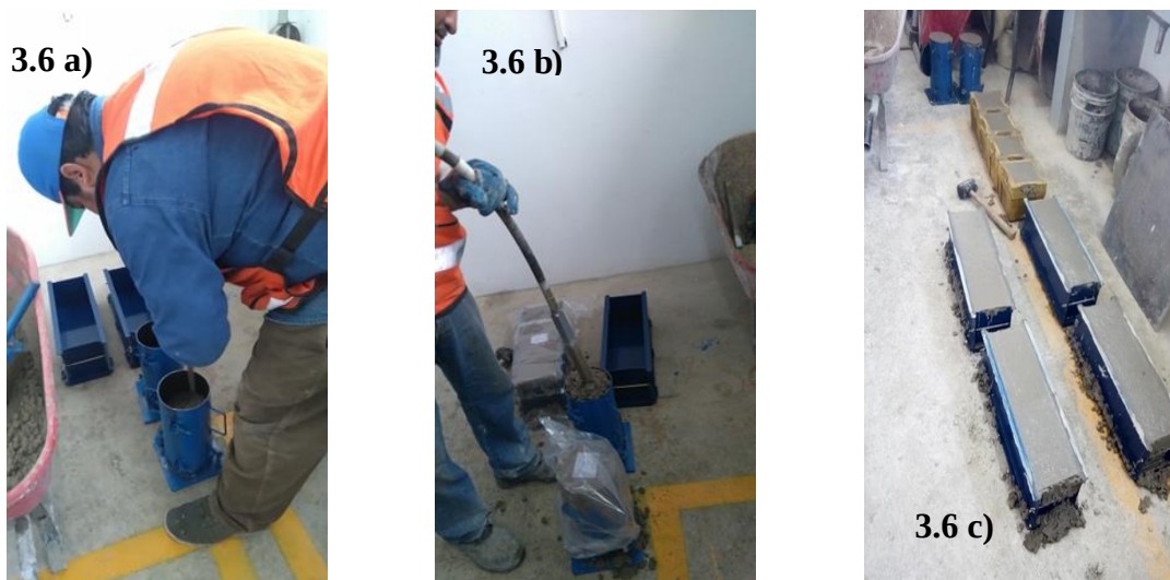
Figura 3.6 a) Elaboración de muestras cilíndricas, b) Elaboración de muestras cúbicas, c) Elaboración de muestras prismáticas. Referencia 16.- El Autor.
