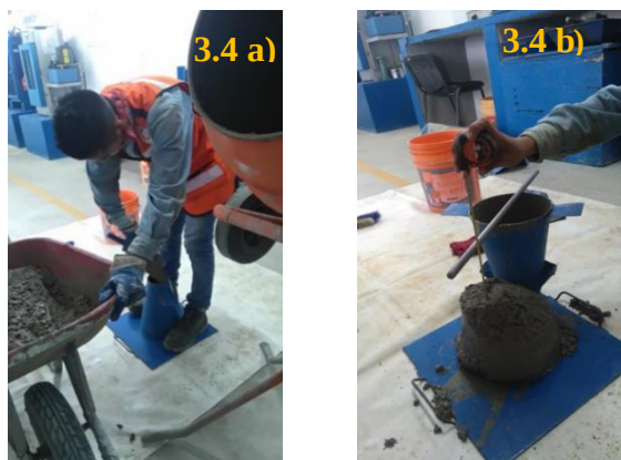
Figura 3.4 a) Toma de muestra del concreto fresco en laboratorio, b) Determinación del revenimiento del concreto fresco. Referencia 16.-El Autor
