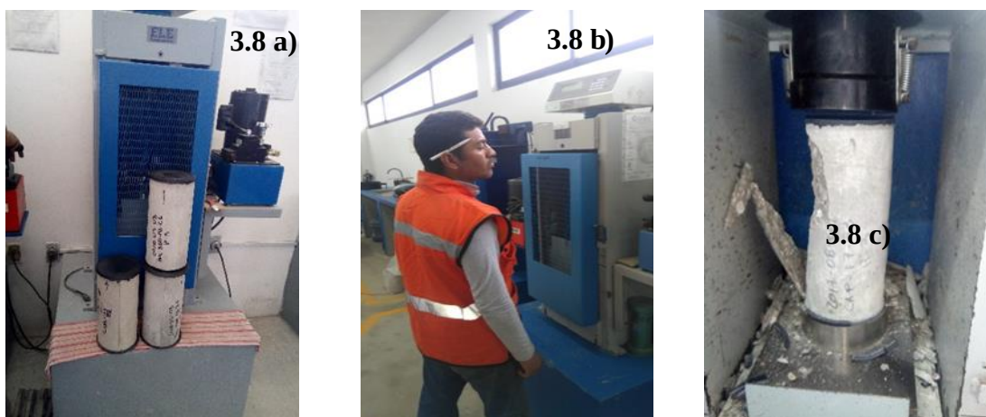
Figura 3.8 a) Muestras de especímenes cabeceados, previo a ensayarse a compresión. b) Ensayo a compresión de especímenes cilíndricos en prensa eléctrica de 200 ton. c) Especímen de concreto ensayado, dentro de prensa. Referencia 16.- El Autor.
