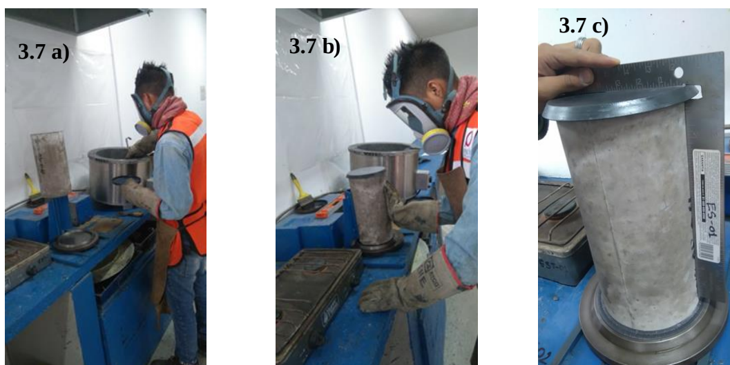
Figura 3.7 a) Vaciado de mortero de azufre liquido en plato de cabeceo, b) Colocación del cilindro de concreto en el mortero de azufre, c) Medición del paralelismo y la perpendicularidad de ambas caras cabeceadas del espécimen. Referencia 16.- El Autor.
