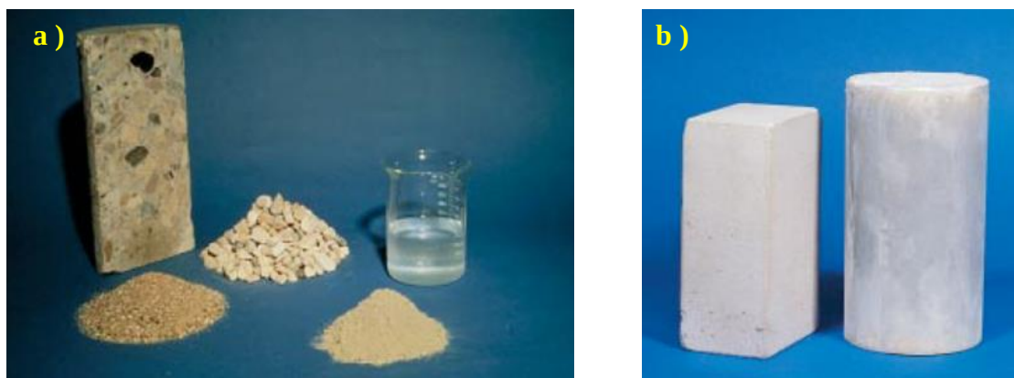
Figura No. 1.3 a) Componentes del concreto: Cemento, agua, agregado fino y agregado grueso, b) Piedra de cantera de la isla de Portland.
