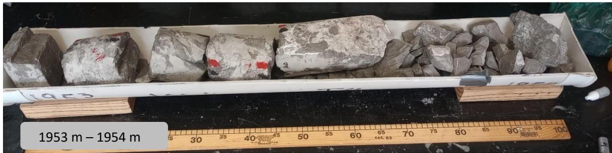
Figura 1. Núcleos de rocas calcáreas recuperados del pozo Agrícola Oriental 2C
