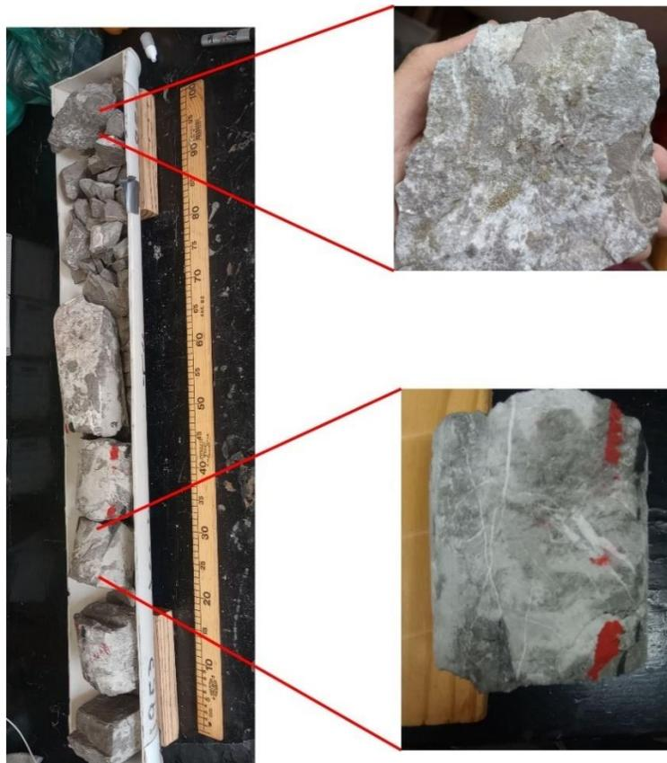
*Figura 17. Tramo de 1953 a 1954 m. En la parte superior derecha se observa una muestra con pirita diseminada y en la parte inferior una muestra del núcleo con vetas de calcita.*
