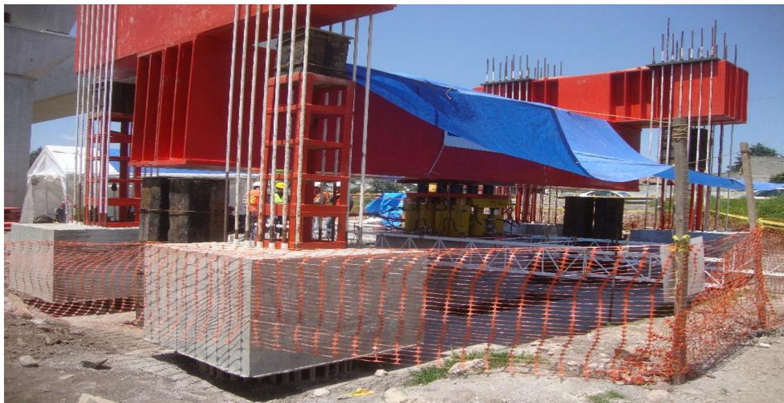
Imagen 3.10. Prueba de carga axial de pila de cimentación
