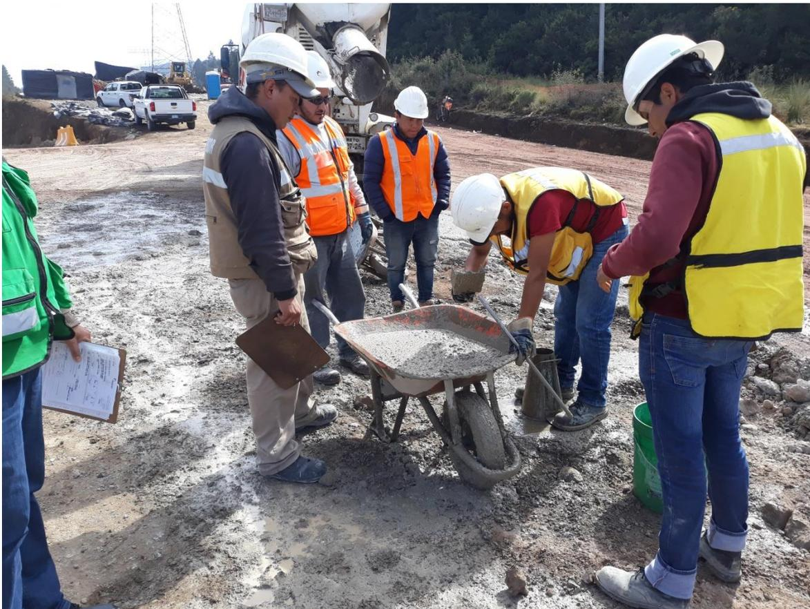
Imagen 5.39 pruebas de revenimiento en concreto fresco para verificación de trabajabilidad
