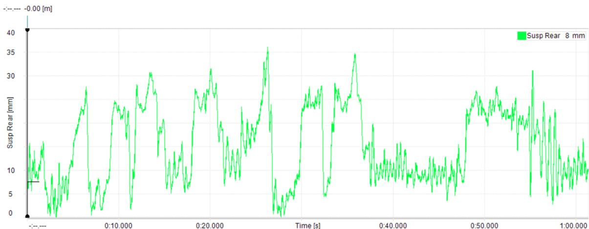
Imagen 3.4: Gráfica del desplazamiento de la suspensión trasera contra el tiempo del amortiguador a lo largo de una vuelta.
