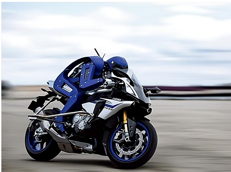
Figura 3.3: Yamaha Motobot en acción en una pista de carreras. [49].
