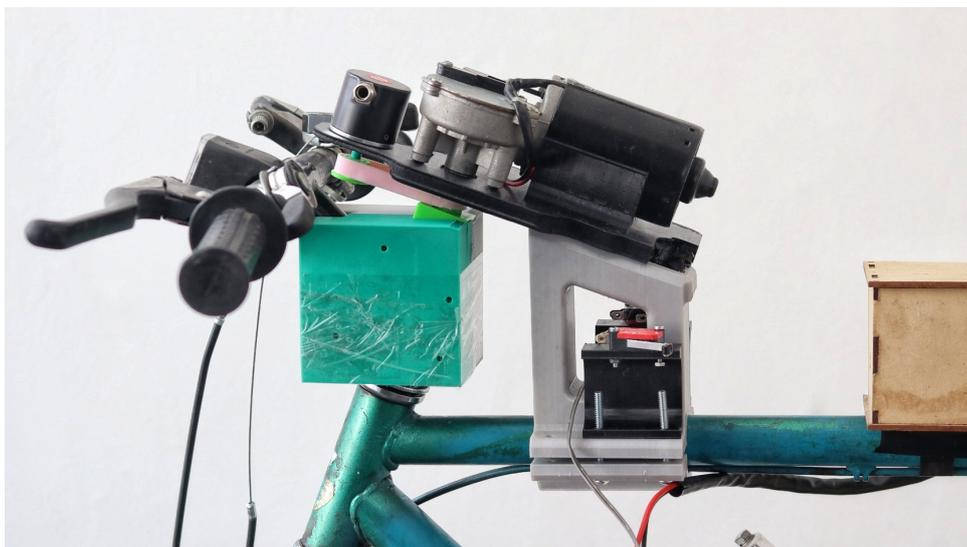
Figura 4.39: Estructura de conexión entre el motor Gimson, el manubrio y el encoder.
