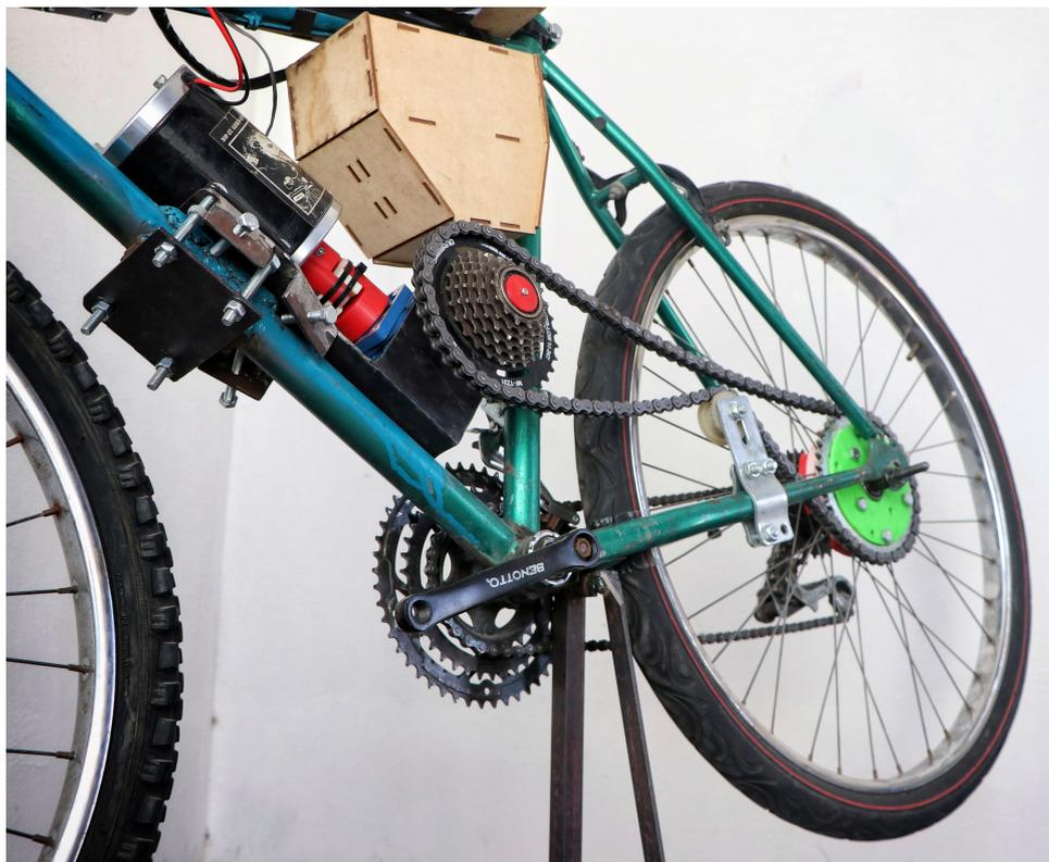
Figura 4.40: Transmisión de par desde el motor My1020 a la llanta trasera.
