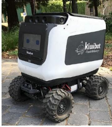
Figura 1.6: Kiiwibot, robot autónomo de entrega utilizado en campus universitarios. Fuente: [4].
