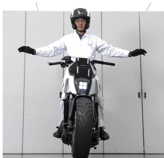
(b) Prueba de estabilidad donde el piloto permanece de pie sobre la motocicleta sin sujetar el manubrio, que se mantiene estabilizada [46].
