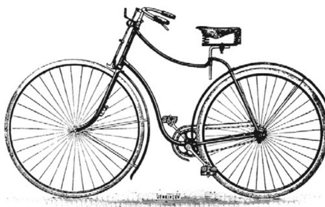
Figura 2.6: Bicicleta de seguridad. Imagen tomada de [11].
