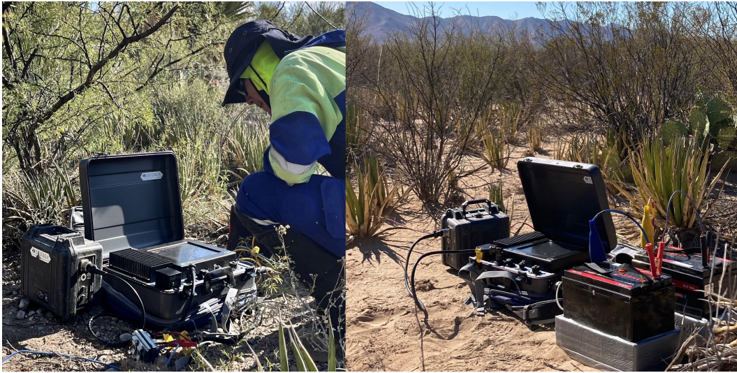
Figura 9: Equipo TerraTEM24 y baterías en campo
