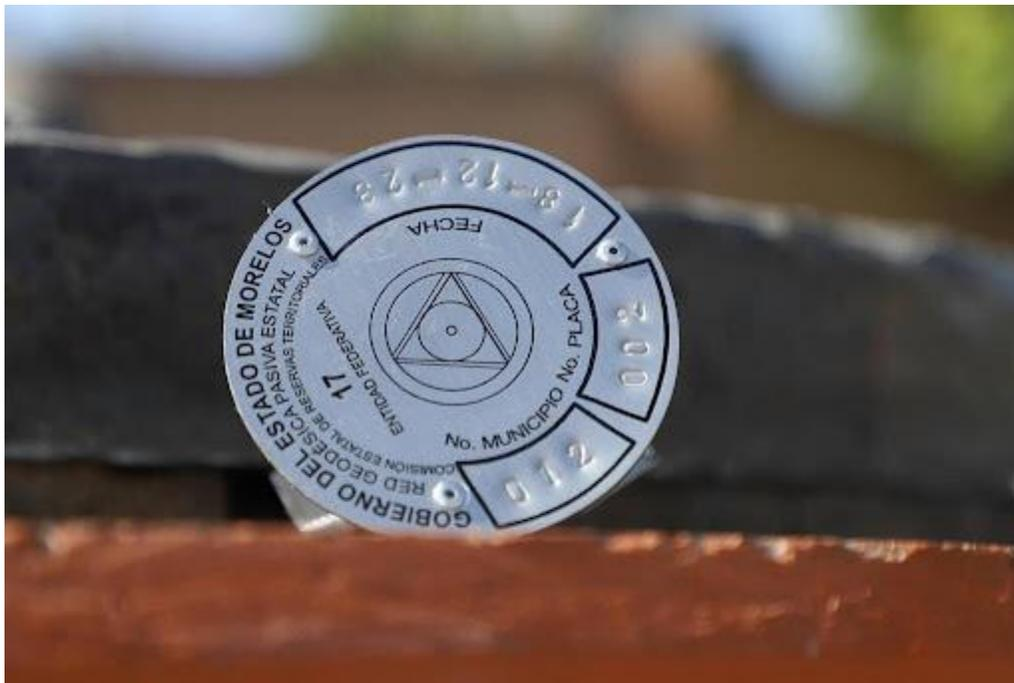
Figura 26. Placa que conforma la RGNP (INEGI, 2025)
